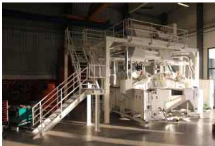
Obr. 1: Tryskací zařízení pro klikové hřídele je vybaveno třemi tryskacími komorami. Vysoké uživatelské přívětivosti a spolehlivosti přispívá prostorná lávka pro údržbu, díky které jsou všechny komponenty, které je třeba udržovat, snadno a rychle přístupné.
