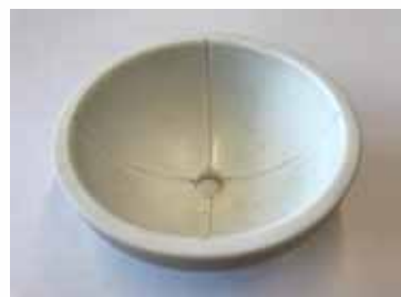
Obr. 7: Pouzdro kulového čepu z polyoxymethylenu (POM)
