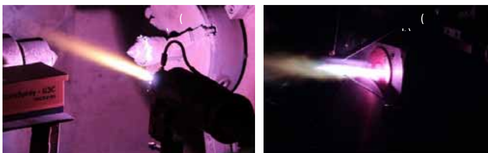
Obr. 6: Technologie plazmatického nástřiku (a) atmosférický plazmatický nástřik, a (b) vodou stabilizovaný plazmatický nástřik.
