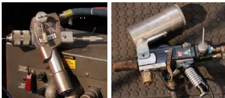
Obr. 3: Hořáky pro nástřik plamenem s výchozím přídavným materiálem ve formě (a) drátu, a (b) prášku.
