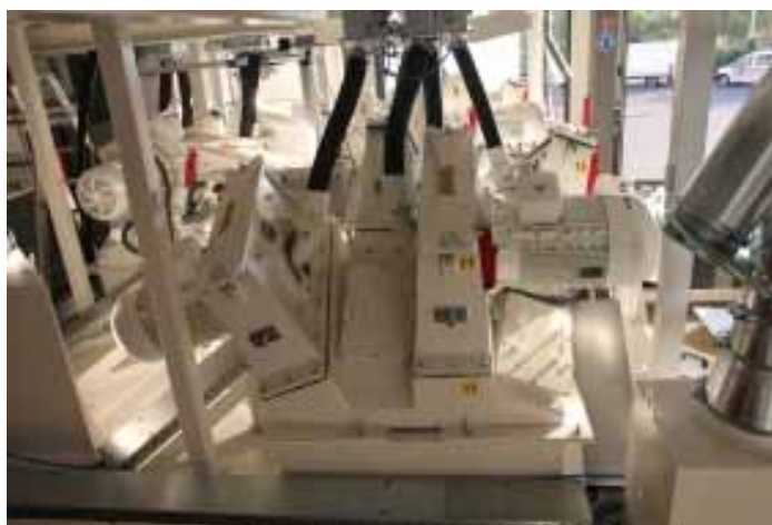
Obr. 2: Každá ze třech tryskacích komor je vybavena čtyřmi metacímí koly Gamma 400 G s výkonem pohonu 22 kW. Díky simulaci se zajistí přesná pozice metacímí kol, aby všechny oblasti rozdílných klikových hřídelí byly optimálně otryskány. Speciálně vyvinuté upínky jsou vybaveny pro díly dlouhé 300 až 500 mm a o hmotnosti mezi 6,5 a 18 kg.
