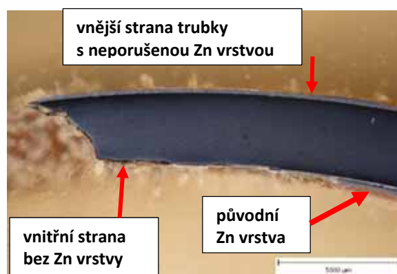
Obr. 11 a 12: Detail místa perforace trubek
