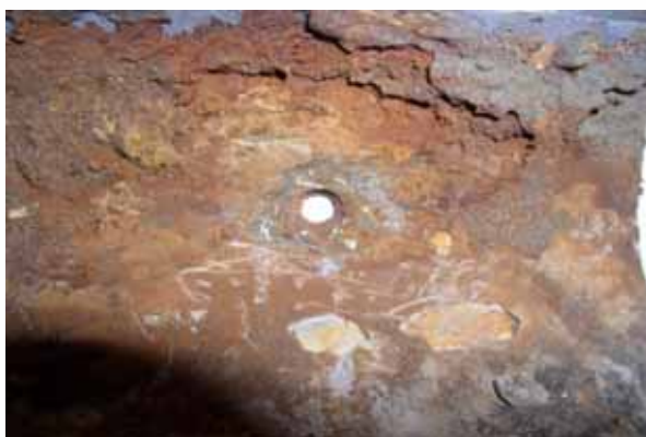
Obr. 5: Vnitřní povrch s proděravěným místem
