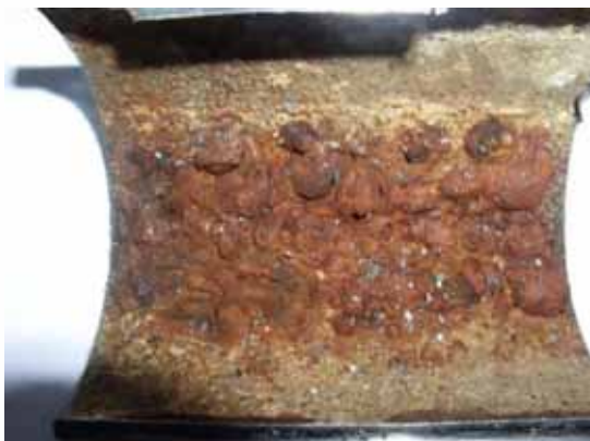
Obr. 3: Korozní puchýře na vnitřním povrchu trubky v teplé vodě
