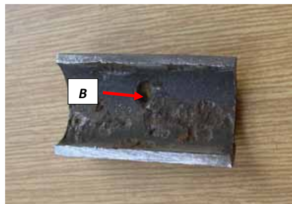
Obr. 7 a 8: Vnitřní povrchy trubek po odstranění korozních zplodin
