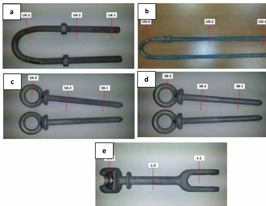
Obr 1: Předměty výzkumce fázi I: a) U-šroub krátký, b) U-šroub dlouhý, c) svorník s okem SA, d) svorník s okem SB, e) spojovací prvek; UK-1, UK-2, UK-3, UD-1, UD-2, UD-3, SA-1, SA-2, SA-3, SB-1, SB-2, SB-3, Ł-1, Ł-2, Ł-3- vzorkovací body pro test obsahu vodíku
