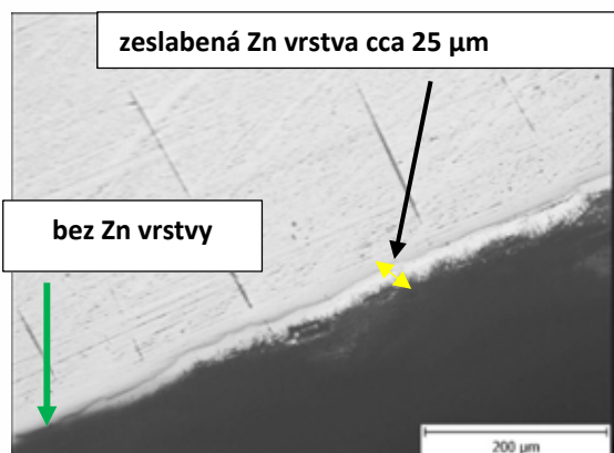
Obr. 15: Tloušťka zeslabené vnitřní Zn vrstvy v blízkosti důlku
