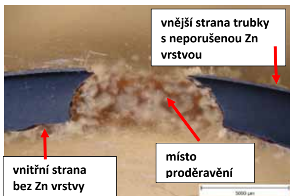
Obr. 11 a 12: Detail místa perforace trubek
