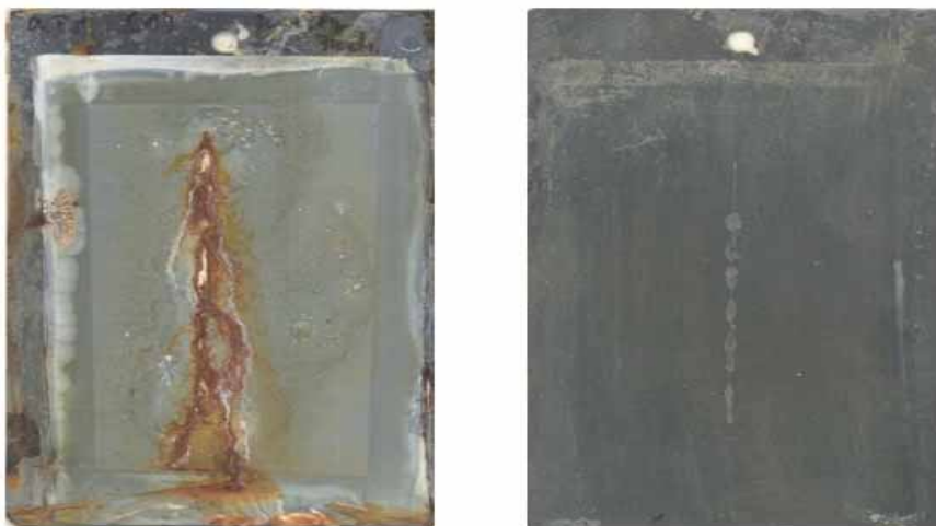
Obr. 4. Nátěrový film a ocelový panel po sejmutí nátěrového filmu s obsahem Zn + ZnSe \text{OKP}_{\text{ZnSe}}=5\% po 1100 hodinové expozici
