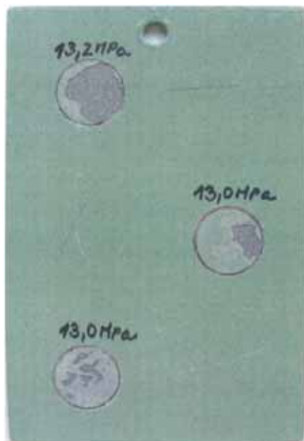
Obr. 4: Vzorek vytvořený elektroobloukovou metodou po odtrhové zkoušce
