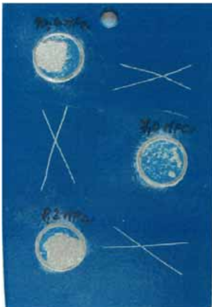
Obr. 3: Vzorek vytvořený plynovou metodou po odtrhové zkoušce
