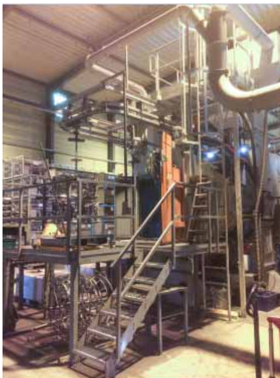
Obr. 1: Výměna metacích kol umožňuje, že tryskací médium dopadá s požadovanou rychlostí na hliníkové tlakové odlitky a tím dosáhne optimální obraz tryskání a zároveň je zkrácena doba tryskání, čímž se zvýší produktivita.
