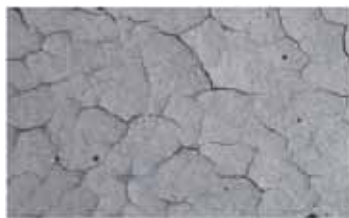
Obr. 1. Bahenní praskání běžného organicky nemodifikovaného ZSN na bázi předhydrolyzovaného ethylsilikátu při tloušťkách nad 150 \mu\text{m} v důsledku smršťování gelového pojiva při jeho zasychání.
