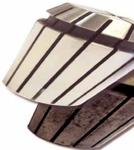
Obr. 2: Porovnání mořeného (horní díl) a nemořeného dílu novou komplexní technologií
