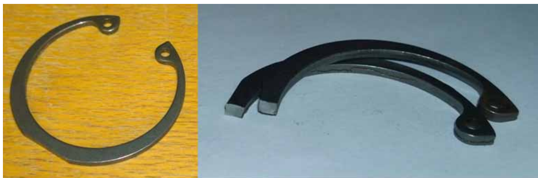
Obr. 4: Zkušební vzorky před a po zkoušení na pulsátoru cyklického namáhání PCN
