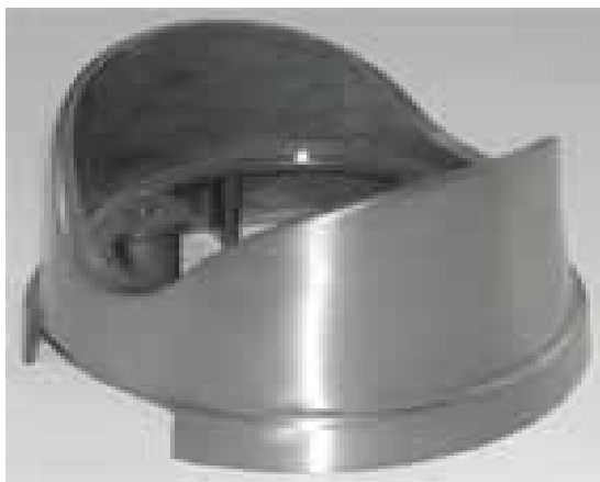
Obr. 3: Díl po chemickém předniklování v lázni, která je součástí Nové technologie
