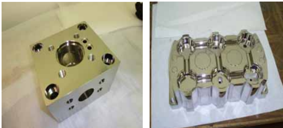
Obr. 4: Díly s finální povrchovou úpravou chemický nikl po předchozím chemickém předniklování
