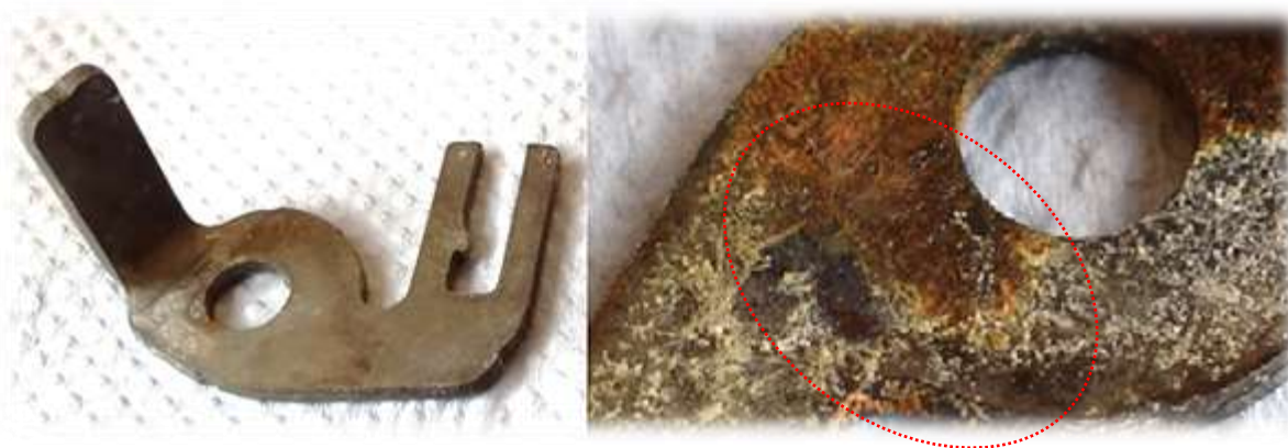
Obr. 7 : Selhání PÚ vlivem vysoké vrstvy Zn
