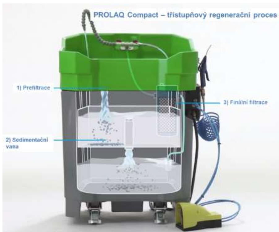
Obr. 2: PROLAQ Compact filtrační systém - prefiltrace (hrubý, jemný filtr a filtrační tkanina), Sedimentační vana (sedimentace barvy a přebytek čisté kapaliny), Finální filtrace (zachycení nejmenějšího znečištění ve filtrační patroně 25 \mu m)
