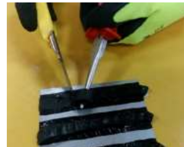
Obr. 4: Zkouška kvality lepení odlupováním housenky
