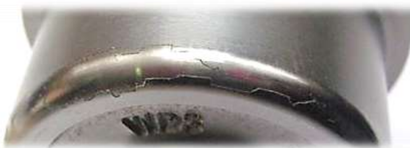
Obr. 8 : Selhání adheze pokovení
