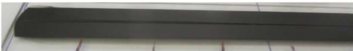
Obr. 3: Výsledek zkoušky zasychání metodou lineárního záznamu
