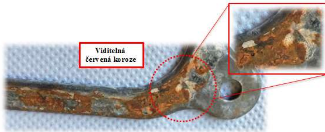
Obr. 4 : Selhání Zn ochrany v NSS testu po 720 hodinách
