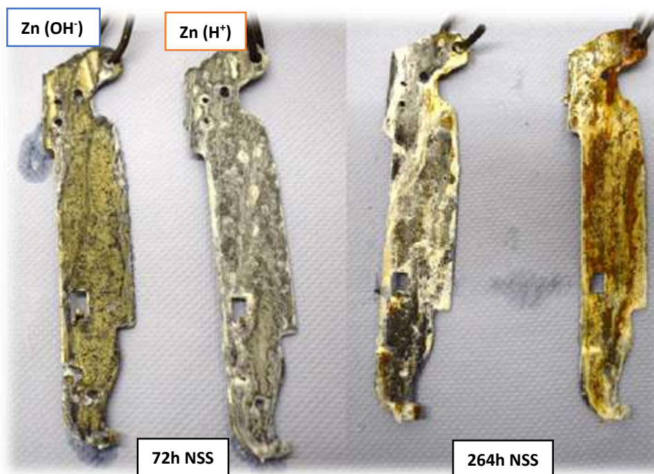
Obr. 5 : Srovnání kvality \text{H}^+ a \text{OH}^- procesu zinkování
