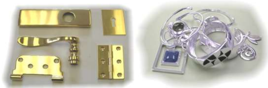
Obr. 5: Vlevo: Čirý povlak KTL na leštěné mosazi, Vpravo: Čirý povlak KTL na stříbře
