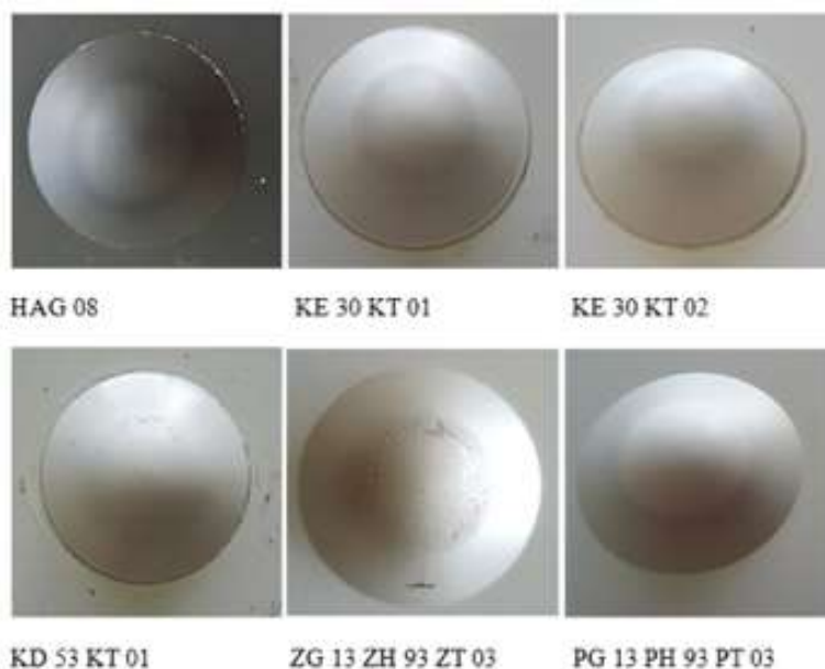
Obr. 5: Charakteristický vzhled povlaků po zkoušce hloubením
