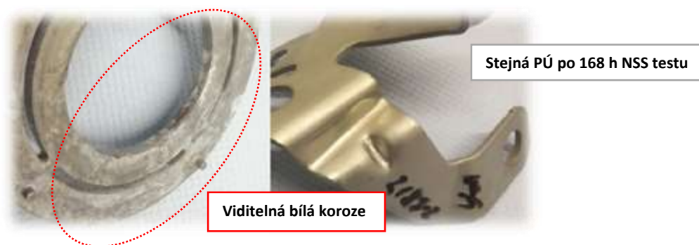
Obr. 3 : Ukázky Zn/Ni pokovení se silnou pasivací v NSS testu
