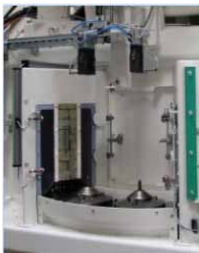
Obr. 2: Tryskací zařízení s metacími koly je vybaveno 16-ti satelity pro upínání dílů, které bezproblémově splňují předpoklad zadaného množství vsázky 240 dílů za hodinu.
