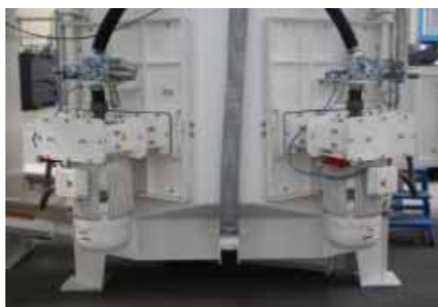
Obr. 3: Obě vysoce výkonná metací kola Rutten Gamma 400 jsou umístěna horizontálně v oblasti tryskání. Tímto mohou být opracovány vždy dva díly zároveň.
