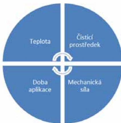
Obr. 2: Výsledek čištění je dán vzájemnou souhrou čtyř faktorů (tzv. Sinnerův kruh)
