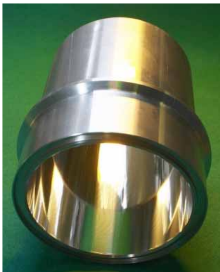
Obr. 2: Příklad povlakované litinové vložky s povlakem TiO_2 na vnitřní funkční ploše [8]
