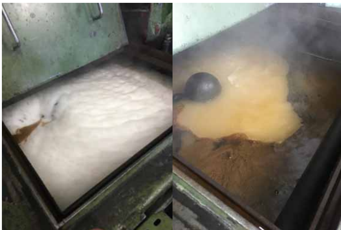
Obr. 9 a 10: Čištění po kalení do oleje (vlevo), vpravo stejná lázeň po doplnění tensidu SurTec 086
