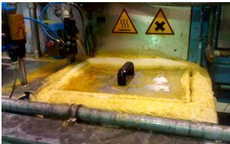
Obr. 8: Typický následek zmýdelnatělých olejů v odfosátovací lázni: prakticky žádné odlučování oleje na odlučovači a vysoká pěnovitost v celém systému. O náročnosti čištění a údržby takové linky není pochybností
