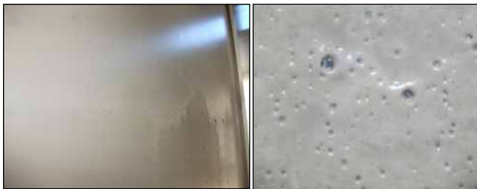
Obr. 2: Vlevo: Typický defekt laku (KTL) na pozinkovaném plechu s nedostatečně odstraněnou pasivní vrstvou (pasivace ochlazovací lázně). Vpravo defekt při 40x zvětšení
