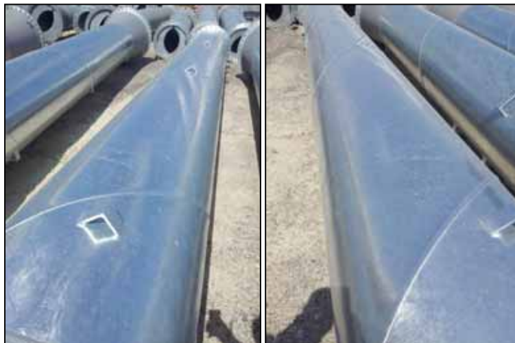
Obr. 1: Díly s pasivací SurTec 540 před (vlevo) a po 2 měsíční venkovní expozici – bez změny lesku povlaku
