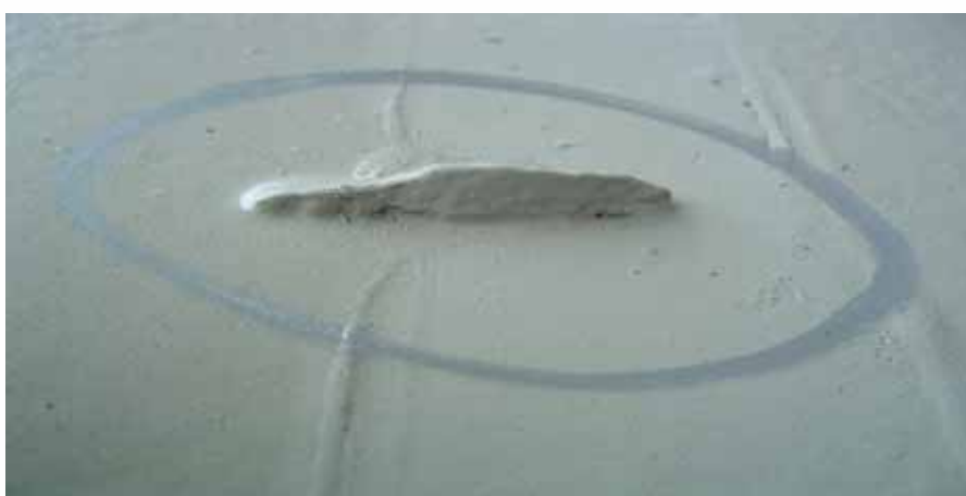
Obr. 3: Nedůsledně odstraněná část svaru po odříznutí manipulačního oka při montáži OK – chybná přejímka před započítím povrchové úpravy.
