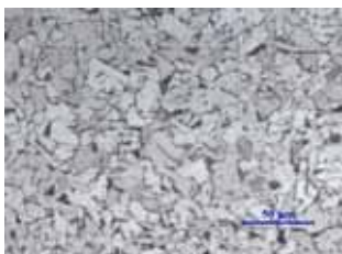
Obr. 1: Mikrostruktura ocele S235JR, podélný řez, zv. 500x
