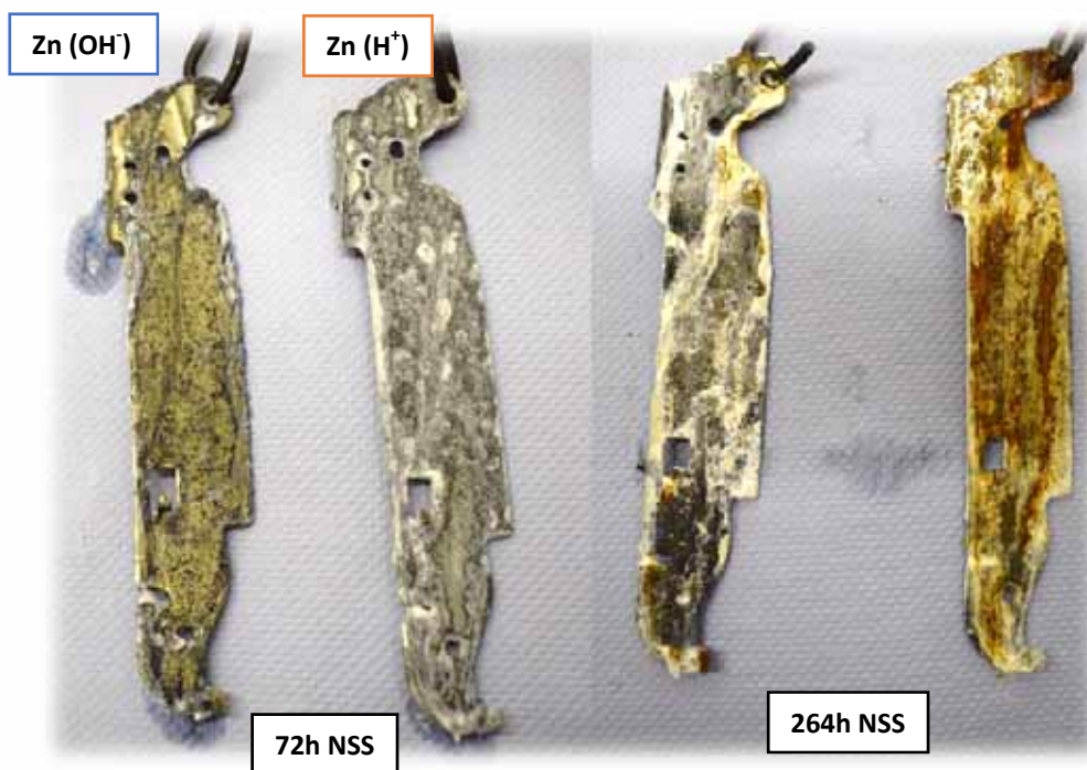
Obr. 5: Srovnání kvality H^+ a OH^- procesu zinkování
