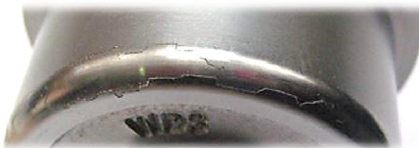
Obr. 8: Selhání adheze pokovení
