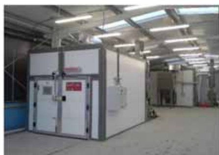
Tlakovzdušná trysková komora typ TTK 6x4x3,5m, TTK 4x3x3m
