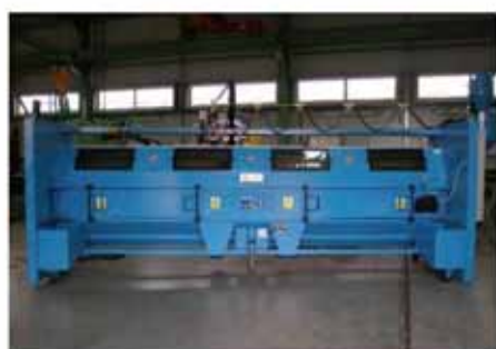
Pneumatické tryskové zařízení automatické s manipulátorem, typ PTZ – ATR
