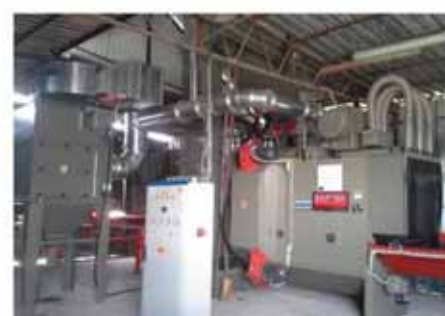
Automatický tryskový stroj průběžný typ 4D 1000x600
