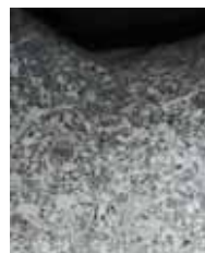
Obr. 2: Plasticky deformovaný povrch mikrostruktury, příčný řez, zv. 500x
