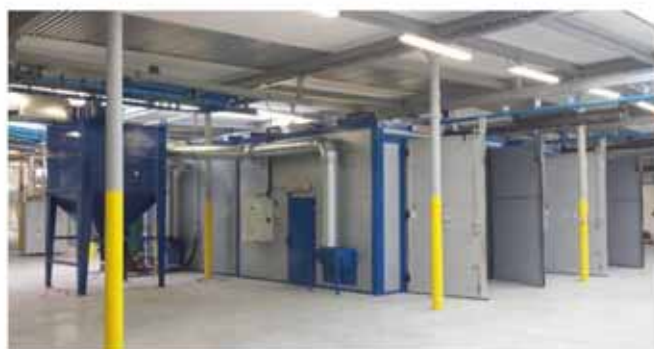
Tlakovzdušná trysková komora typ TTK 9x4,5x3,5m (drť), TTK 9x4,5x3,5m (balotina)
