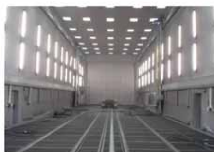
Tlakovzdušná trysková komora typ TTK 36x9,2x9m
