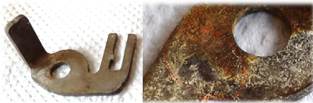
Obr. 7: Selhání PÚ vlivem vysoké vrstvy Zn
