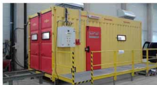
Pracoviště povrchových úprav (tryskání, broušení a žárové nástříky) typ kontejner 6x2,4x3m
