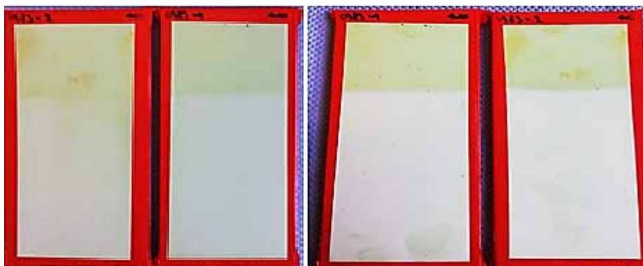
Obr. 10: vzorky analyzovaného NS (kolaps) po 264 h (vlevo) a 500 h (vpravo) Q - UV testu
