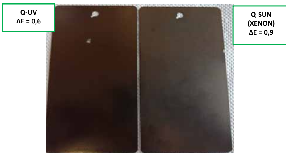
Obr. 7: Porovnání Q-UV a Q-SUN (XENON) na vzorcích světle-stálých NS LV AKZ 421
