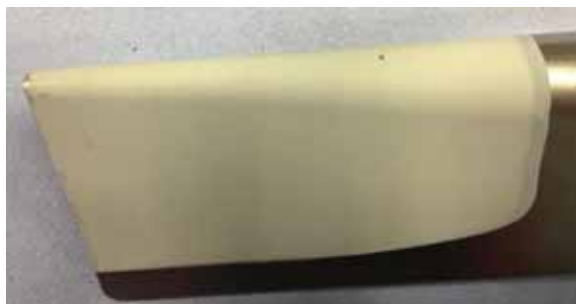
Obr. 2: Ohyb na kónickém trnu
