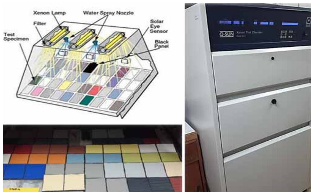
Obr. 4: Schéma a samotné zařízení Q-SUN se vzorky
