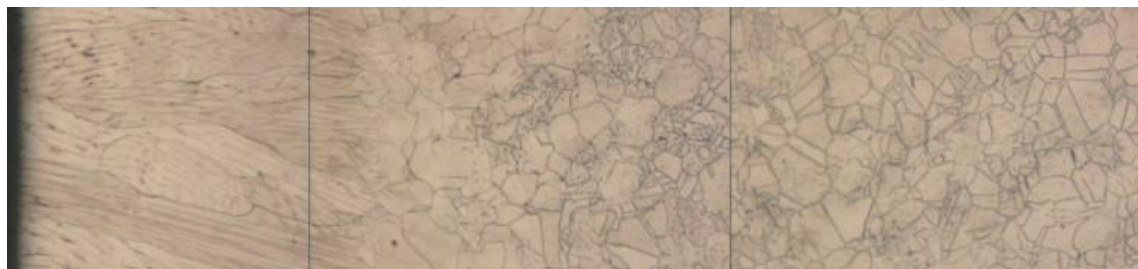
Obr. 6: Tepelne ovplyvnená oblasť po renovácii taniera - výskyt stĺpcovitých zŕn návaru
