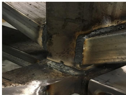
Obr. 2: Vlevo – zeslabení tloušťky PKO z důvodu neupravené hrany výrobku (modrá šipka = viditelný otřep, zelená šipka = okuje), vpravo – z hlediska PKO nedostatečně upravené svary a jejich okolí (rozstřík svarového kovu, rozčrežený svar, ostré hrany,...)
