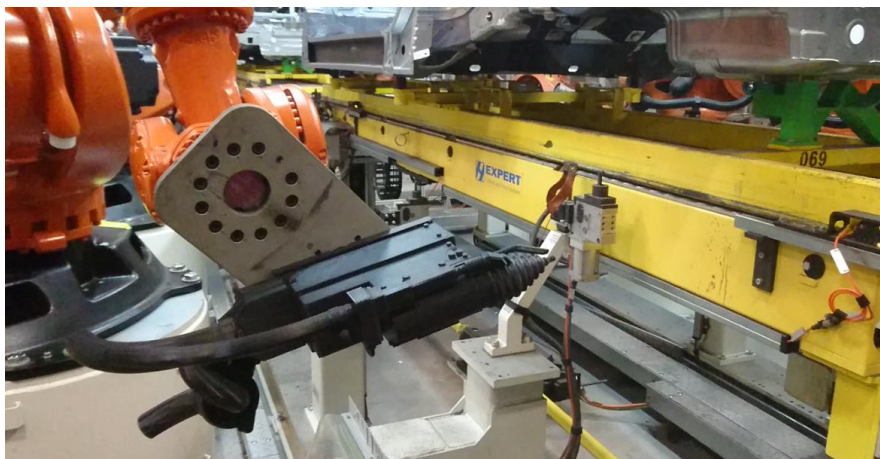
Obr. 9: 3D tisk makety výrobního nástroje
