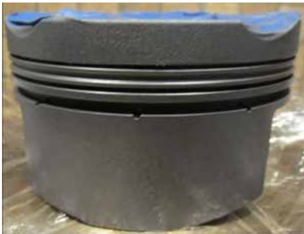
Obr. 2: Aplikace kluzného laku na povrch pístu [4]
