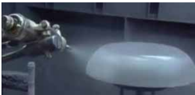
Obr. 3: Technologie nanášení kluzných laků nástřikem [4]
