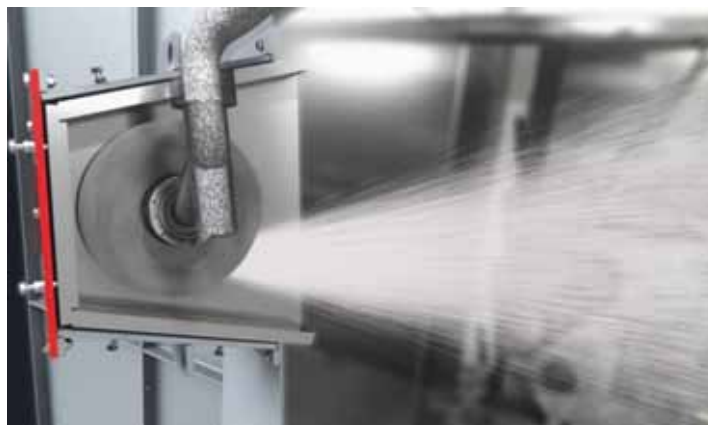
Obr. 2: V porovnání s běžnými metacími koly stejné velikosti nabízí Gamma 400 G o 15 – 20 % vyšší výkon tryskání.
