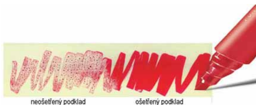
Obr. 1: Příklad použití fixů pro plazmově modifikovaná/ nedomodifikované povrchy -převzato z[1]
