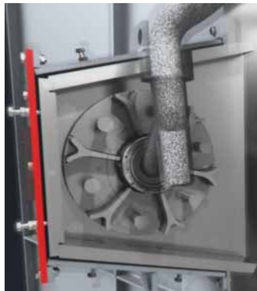
Obr. 1: Díky své svému Y-tvaru mohou být metací lopatky Gamma 400 G použity oboustranně. Pro jejich výměnu není potřeba více než deset minut.
