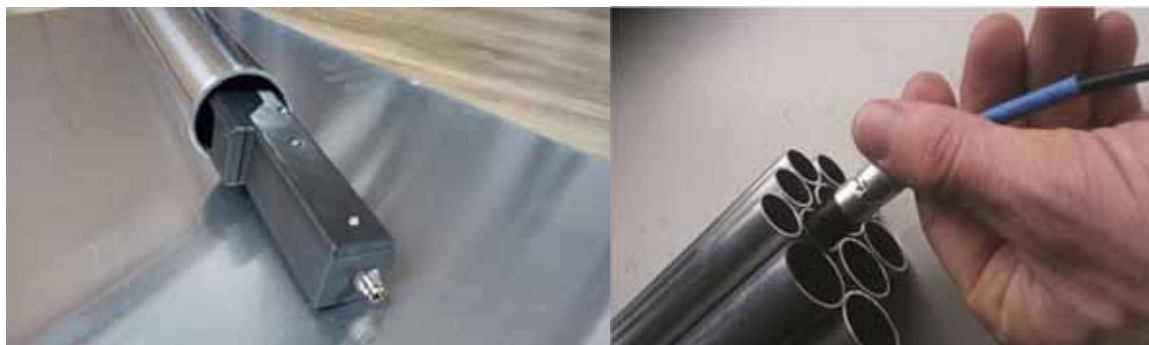
Obr. 6: Recognoil® TubeScanner: pro plošné snímání povrchu trub (vlevo), pro bodové (vpravo)
