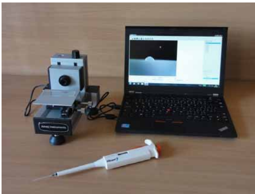
Obr. 2: Zařízení pro určování povrchové energie na principu měření kontaktních úhlů
