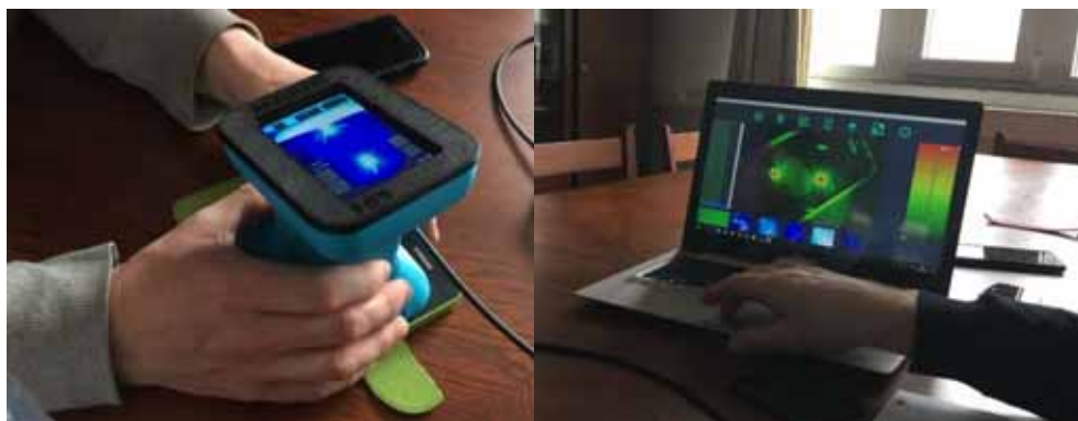
Obr. 7: Prototypový přístroj pro bezkontaktní detekci daktyloskopických stop
