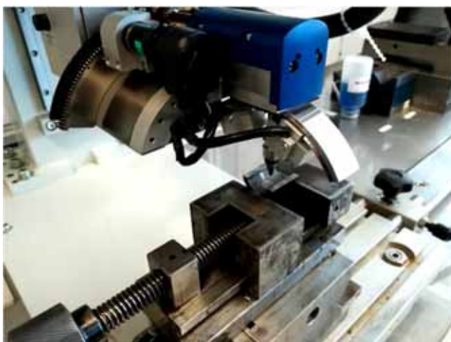
Obr. 9: Ilustrace měření zbytkového napětí na difraktometru Xstress 3000 G2R od fy Stresstech
