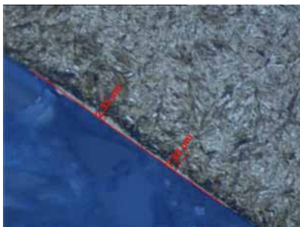
Obr. 3, 4: Metalografické snímky tepelně poškozených vzorků
