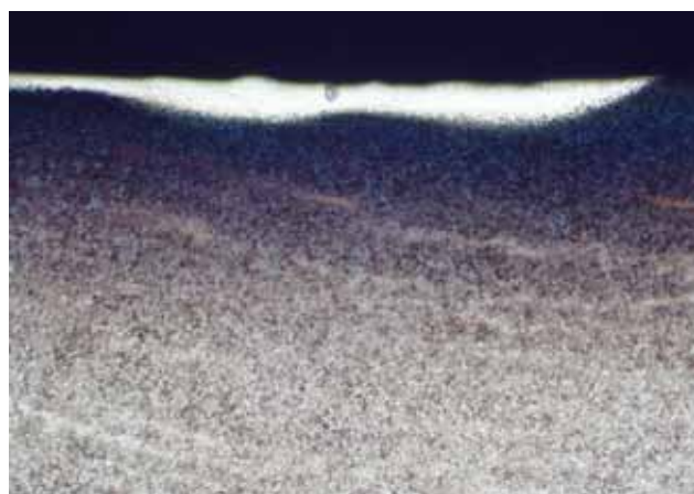
Obr. 3, 4: Metalografické snímky tepelně poškozených vzorků
