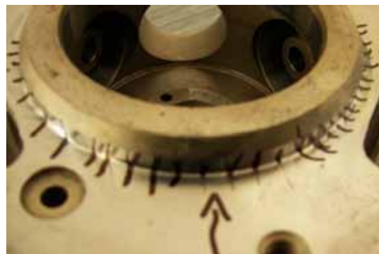
Obr. 2: Těleso čerpadla s brusnými trhlinami
