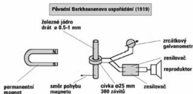
Obr. 7: Původní Barkhausenovo uspořádání
