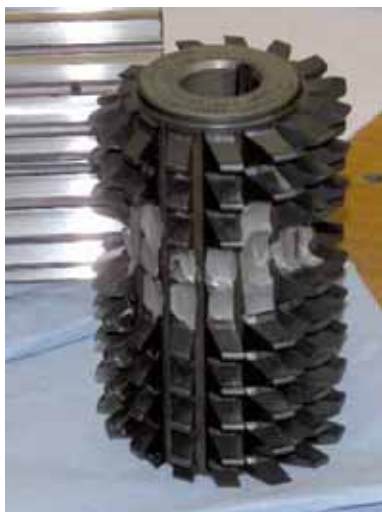
Obr. 1: Fréza po neúspěšném přeastření
