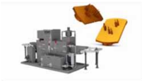
Obr. 3: Přísun dílů do systému a jejich transport do mycího zařízení zajišťuje článkový dopravník a speciální držáky obrobků. V mycím zařízení probíhá mytí a sušení obrobků. Tím je zajištěno, že při čištění budou trvale dodrženy přísné požadavky na čistotu.
