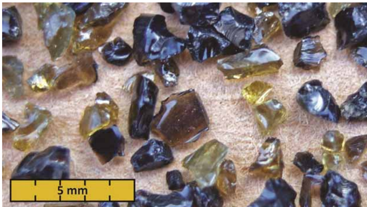
Obr. 1: Makrosnímek tryskacího prostředku Trymat
