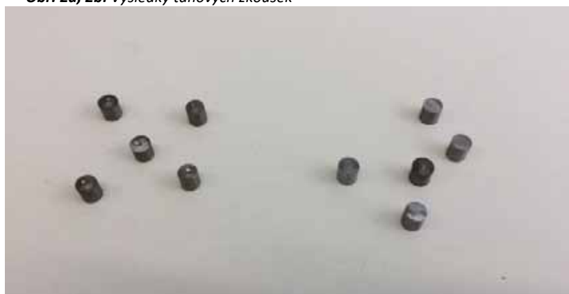
Obr. 3a, 3b: Provedení vzorků pro stanovení obsahu vodíku metodou Inert Gas Fusion
