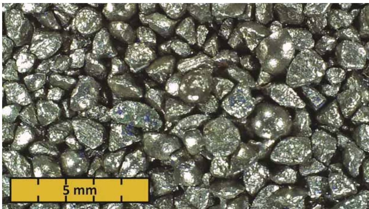
Obr. 3: Makrosnímek částečně použité ocelové drti
