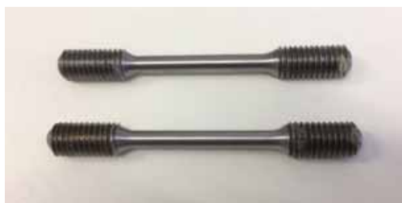
Obr. 1a, 1b: Provedení vzorků pro tahové zkoušky
