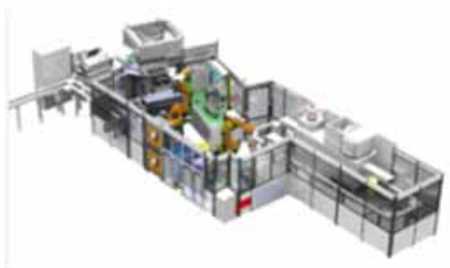
Obr. 1: Kompletní systém zahrnuje odhroťování, jemné čištění, kontrolu kvality, zabalení do boxů KLT a předání boxů do stohovacích kontejnerů.
