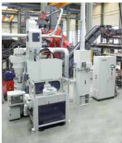
Obr. 1: Tryskacího zařízení Rösler s otočným přepážkovým stolem RWS1200-T1-I4-SAT1 v německém závodě firmy Rösler po úspěšné předpřejímce zákazníkem.
