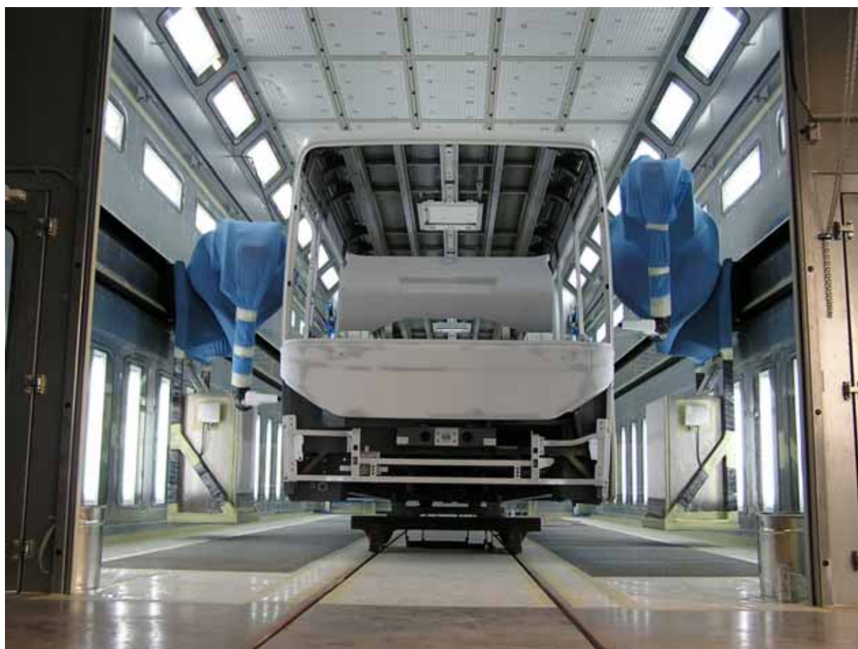
Obr. 3: Robotická lakovna busů IVECO Vysoké Mýto
