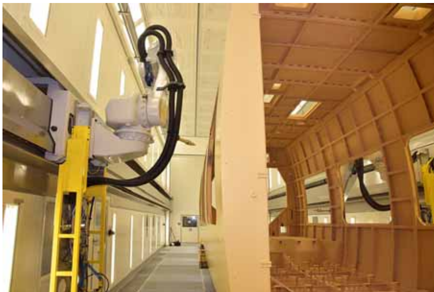
Obr. 4: Robotické lakování vagónu ve firmě Bombardier Transportation
