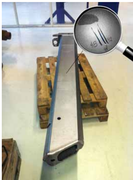
Obr. 9: komponenty tryskané směsí s aditivem mají dobrou smáčivost a je možné je ihned povlakovat
