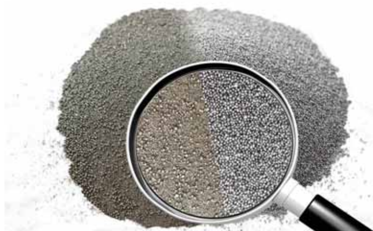
Obr. 12: napravo pracovní směs nepoužitelná v důsledku ucpané filtrace, Nalevo vyčištěná směs s plným abrazivním účinkem
