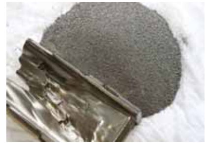
Obr. 4: pracovní směs s vysokým obsahem prachu, vlevo opotřebená lopatka
