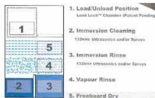
Obr.5: Schéma procesu ultrazvukové parní čistící linky
