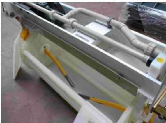
Obr. 3: Bubnená linie s přívody vzduchu a vody do středů čel
