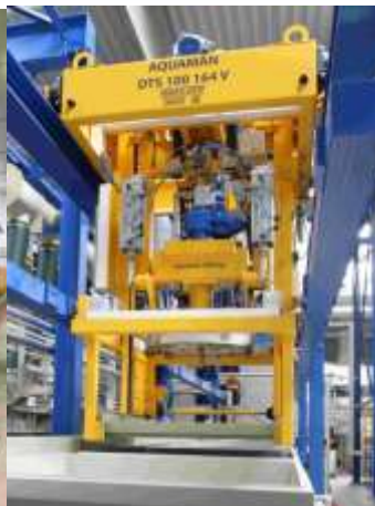
Obr. 10 Speciální transportní manipolátor pro manipulaci s koši
