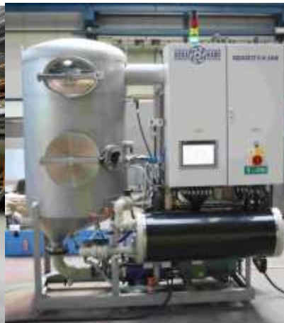
Obr. 15: Vakuová odparka s tepelným čerpadlem
