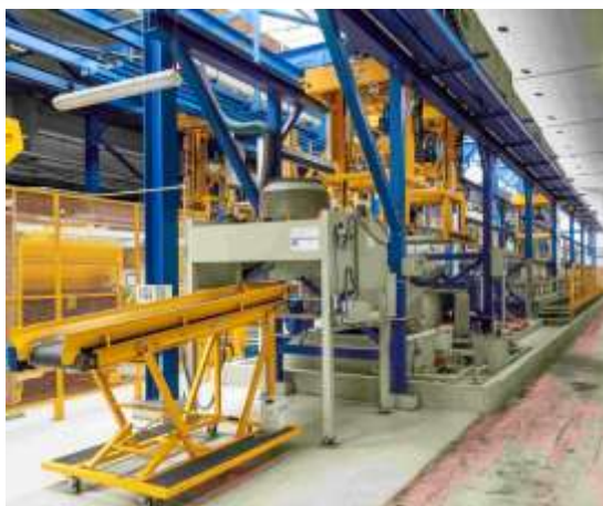
Obr. 9: Speciální zařízení pro následné úpravy hromadně zinkovaných dílů
