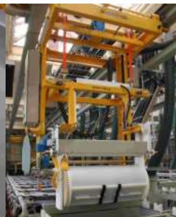
Obr. 5: Dopravník s přívody vzduchu a vody do bubnů
