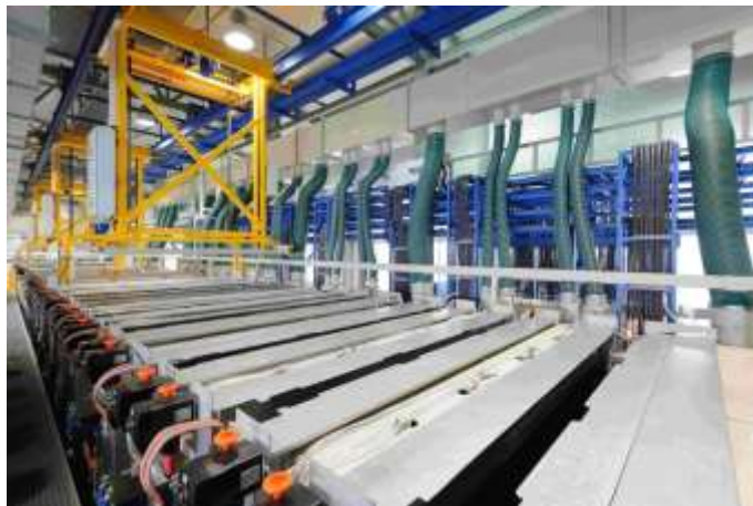
Obr. 1: Závěsová Zn-Ni linka s automatickými víky na vanách
