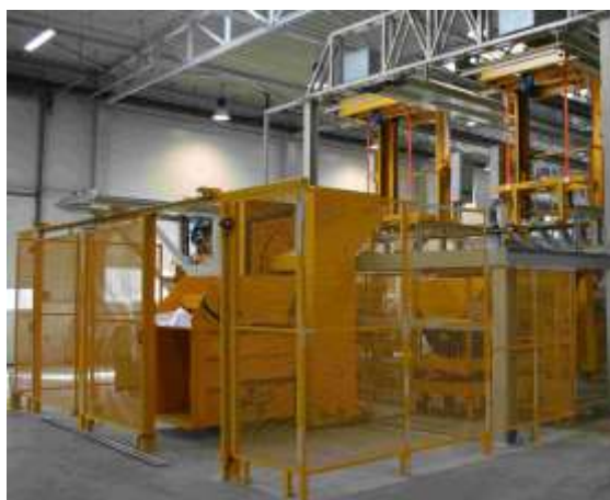
Obr. 11: Plnicí úsek s jedním pojízdným zařízením pro vyklápění palet a dvěma vibračními žlaby pro plnění bubnů dvěma různými druhy zboží
