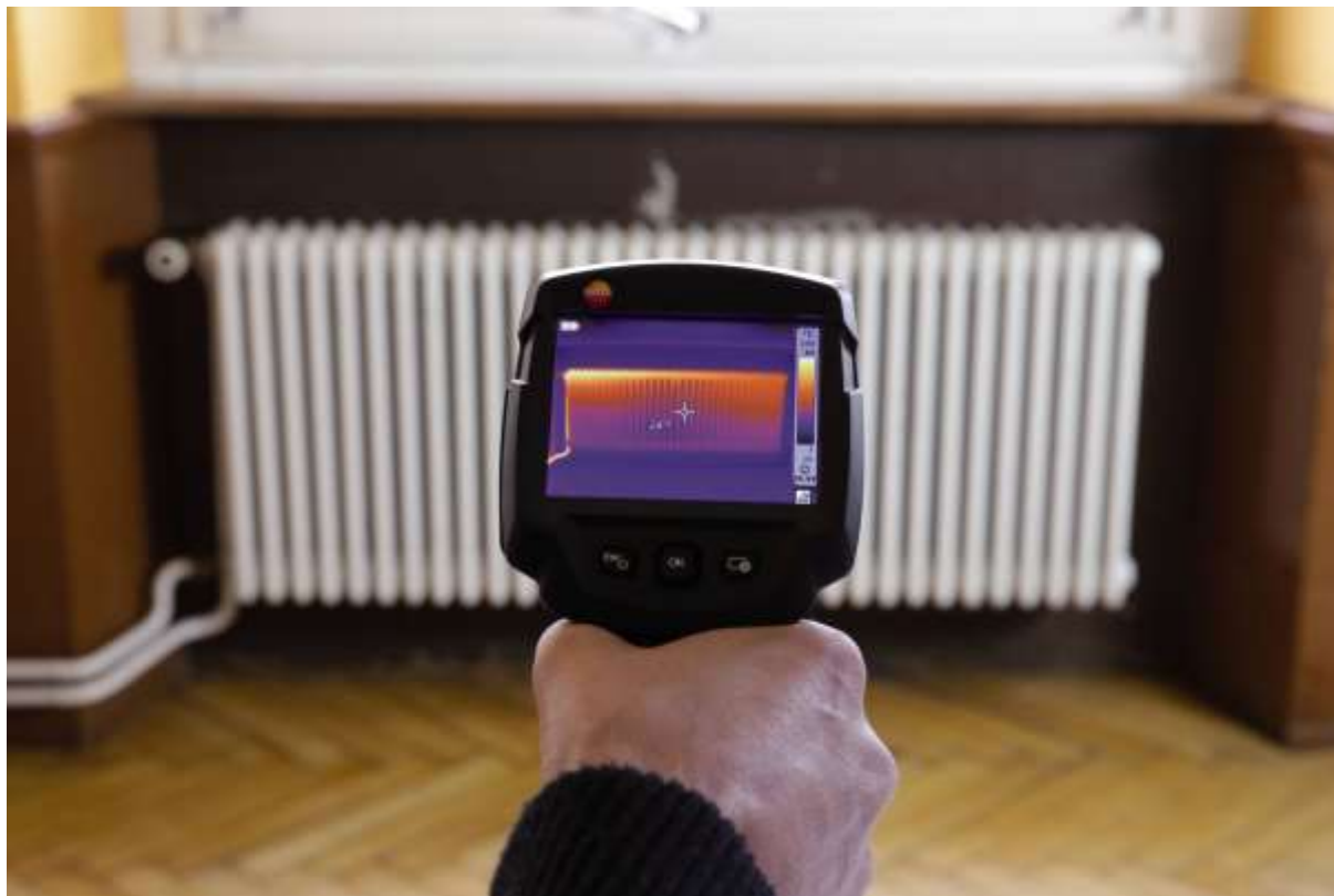
Ukázka zanesení radiátoru bytového domu pomocí termokamery.
