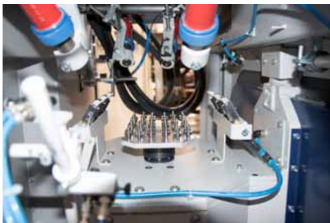
Obr. 4: Detailní pohled na držák obrobku
