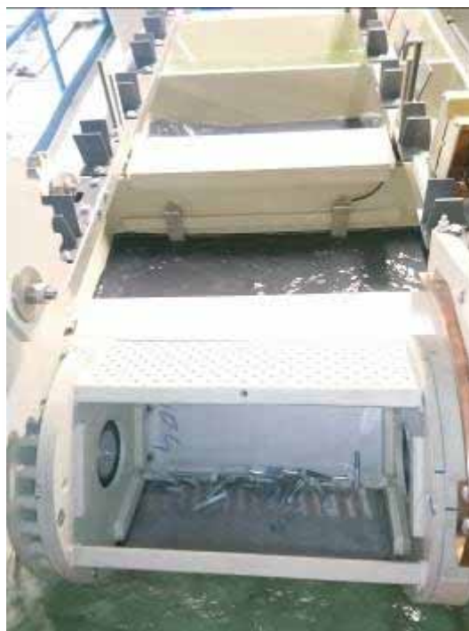
Obr. 3: KTL lakovací buben včetně el. lůžka a kontaktu
