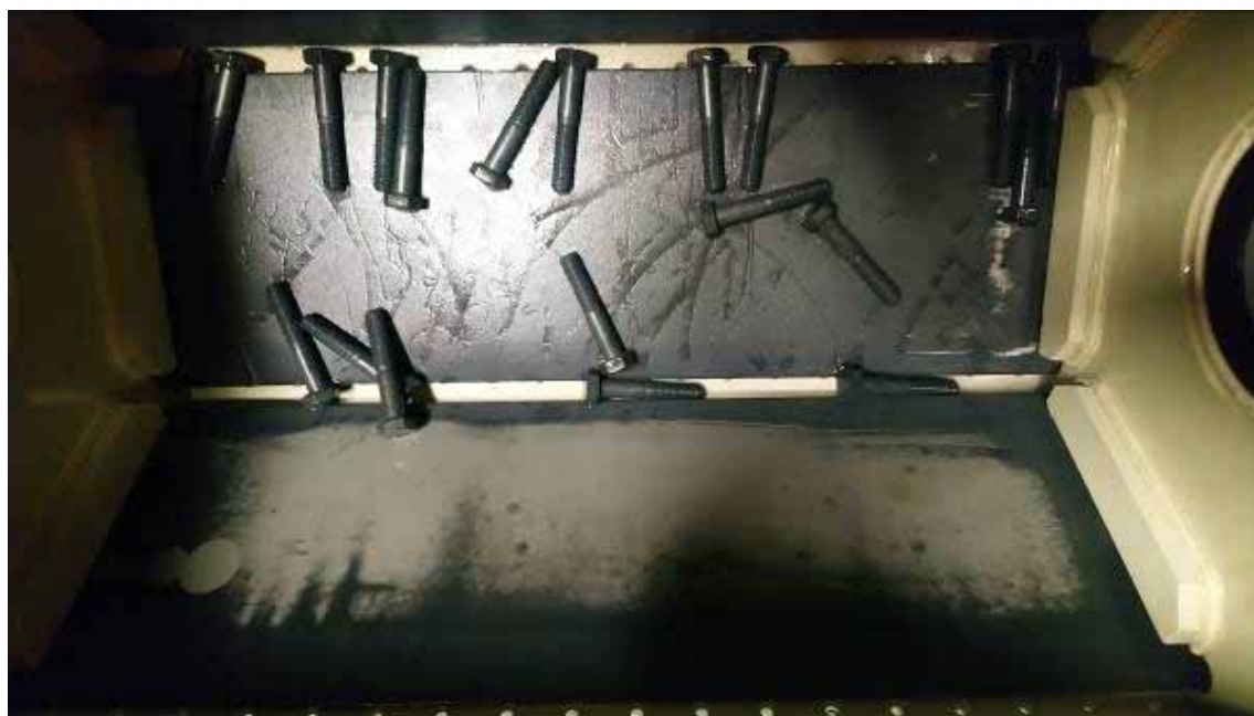
Obr. 4: KTL lakovací buben s nalakovaným šrouby
