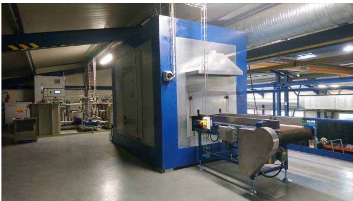
Obr. 2: Polymerizační pec se speciálním pásovým dopravníkem
