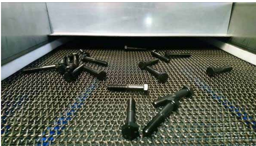
Obr. 5: Drátěný pás polymerizační pece s vypálenými šrouby M8
