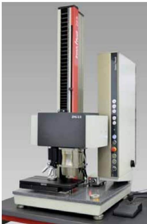
Obr. 4: Indentační zařízení ZWICK; upraveno z [9]
