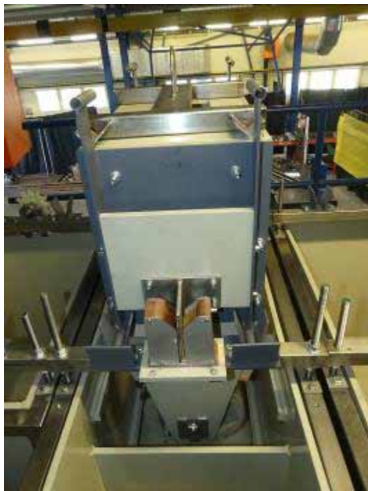
Obr. 3: KTL lakovací buben včetně el. lůžka a kontaktu
