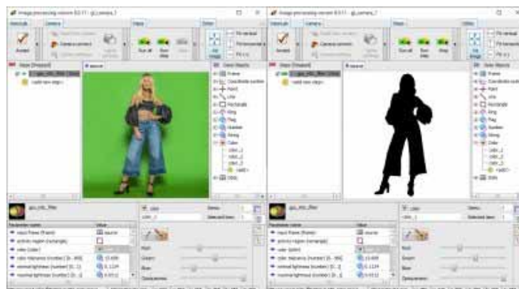
Obr. 3: Oddělení objektu od pozadí prostřednictvím kroku gpu_HSL_filter
