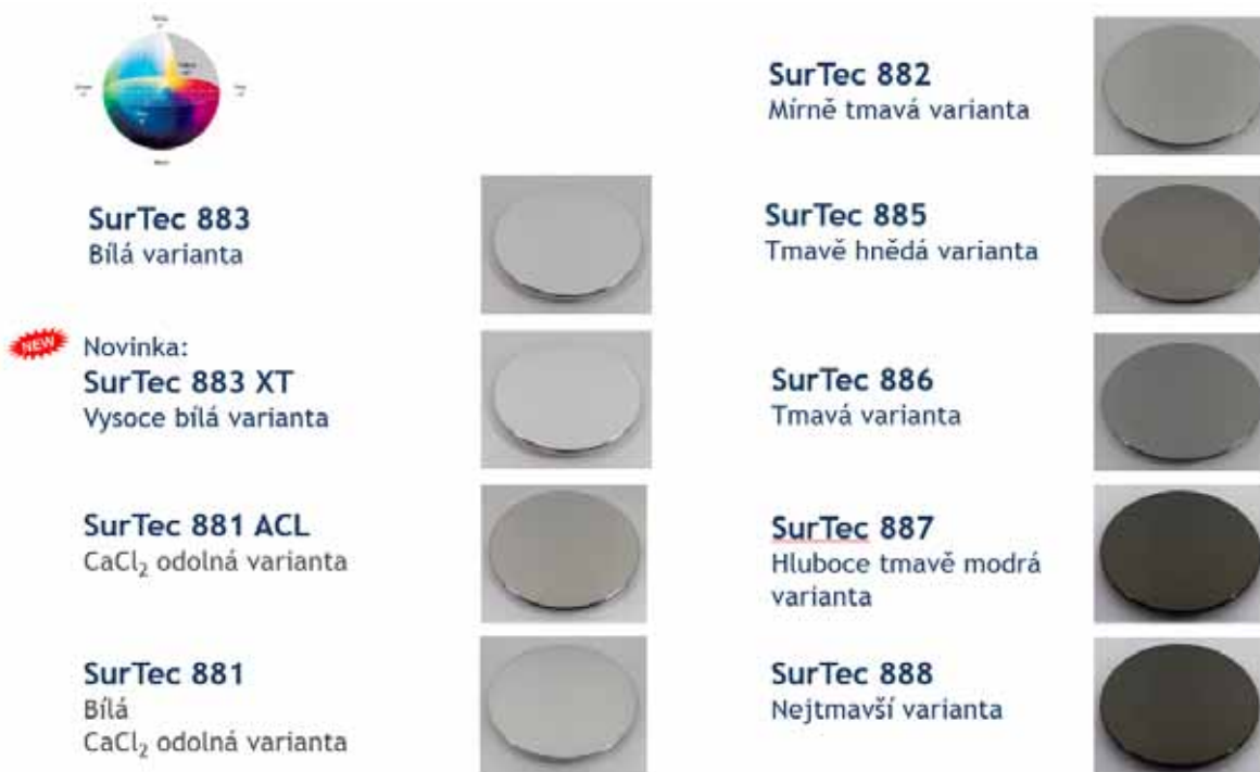
Obr.1: Možné barevné varianty povlaků vyloučených lázněmi řady SurTec 88x
