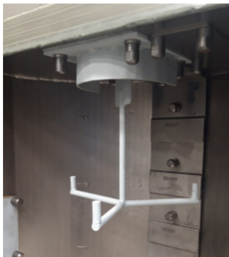
Obr. 3: Jednoduchý trojramenný přípravek umístěný na otočném háku pro zavěšování otryskávaných dílů
