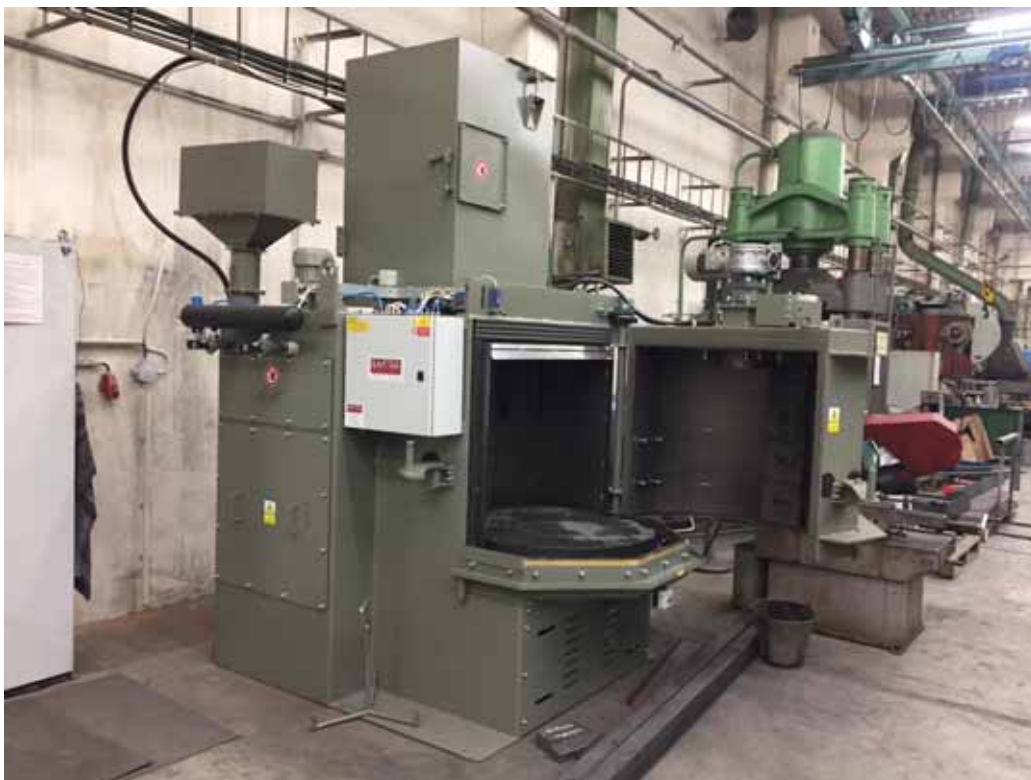
Obr. 1: Automatický stolový tryskací stroj umístěný v poloprovoze Ústavu strojírenské technologie
