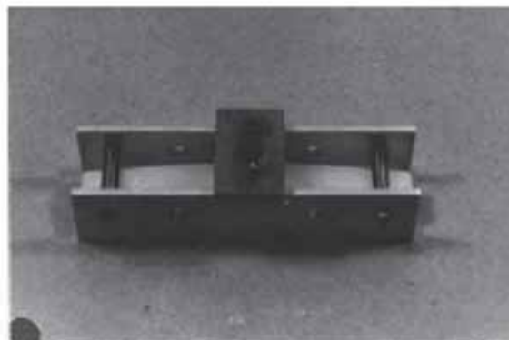
Obr. 4: Přípravek pro testování korozního praskání napětím kombinace lepidel a plastů [4]
