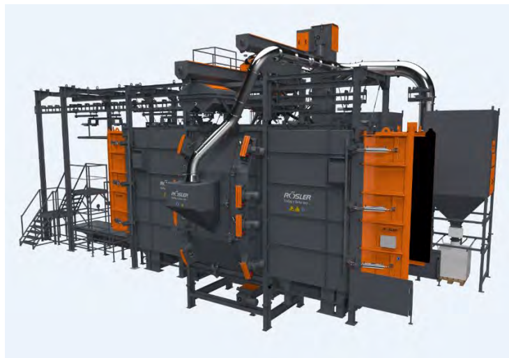
Obr. 1: Tryskací systém, který je určen pro plně automatické tryskání velmi široké škály trojrozměrných svařovaných konstrukcí, zaujme svými reprodukovatelnými výsledky a konstrukcí se sníženým opotřebením, vysokou dostupností a nízkými provozními náklady.
