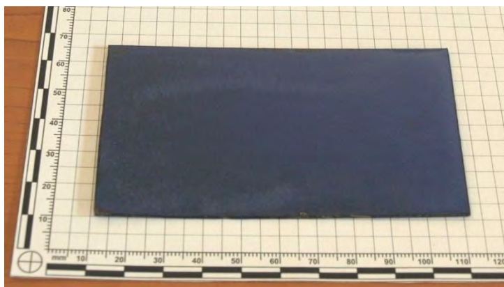
Obr. 3: Zkušební vzorek (kupon) plechu ze smaltéřské oceli po nanesení a vypálení krycího smaltu
