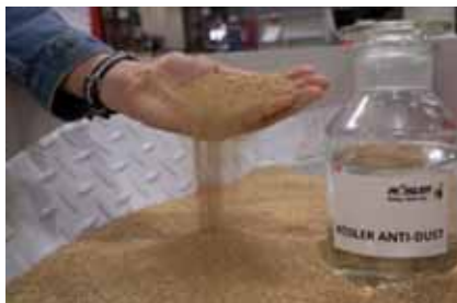
Obr. 3: Snadno dávkovatelná a zdravotně nezávadná přísada Anti-Dust účinně váže prach vznikající při sušení s přírodním granulátem, jako je například kukuřičná drť. Výsledkem jsou čistší obrobky, výrobní prostředí a příjemnější pracovní prostředí.
