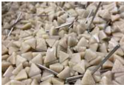
Obr. 2: Při opracování obrobků s plastovými brusnými tělísky zvyšuje nová varianta N bez pěny reprodukovatelnost výsledku, zlepšuje ekonomickou efektivitu, produktivitu a udržitelnost.
