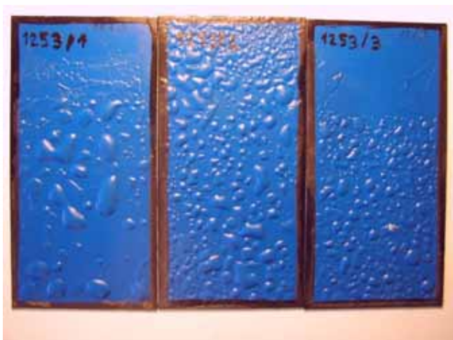
Obr. 3: Příklady typických defektů, objevujících se při korozních testech; vlevo rozsáhlé puchýřkování při zkoušce v kondenzační komoře (ISO 6270-2CH), vpravo je pak na ocelovém panelu pro stavbu lodí po 4200 hodinách expozice v cyklickém korozním testu NORSOK M 501 patrná masivní koroze v okolí řezu, zhotoveného vertikálně i horizontálně nátěrem
