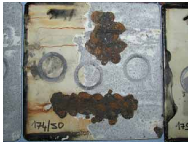
Obr. 3: Příklady typických defektů, objevujících se při korozních testech; vlevo rozsáhlé puchýřkování při zkoušce v kondenzační komoře (ISO 6270-2CH), vpravo je pak na ocelovém panelu pro stavbu lodí po 4200 hodinách expozice v cyklickém korozním testu NORSOK M 501 patrná masivní koroze v okolí řezu, zhotoveného vertikálně i horizontálně nátěrem
