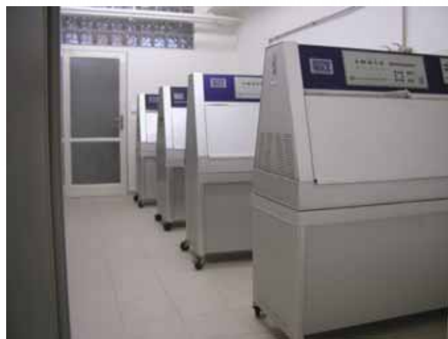
Obr. 2: Zařízení pro dvoufázové cyklické zkoušky – nalevo kondenzační komora s dávkovačem plynného SO 2 pro zkoušku dle DIN 50018 – 2.0 S, napravo zařízení pro urychlenou povětrnostní zkoušku s kondenzací vlhkosti a expozicí pod UV lampami dle tabulky 4 standardu ČSN EN ISO 16474-3
