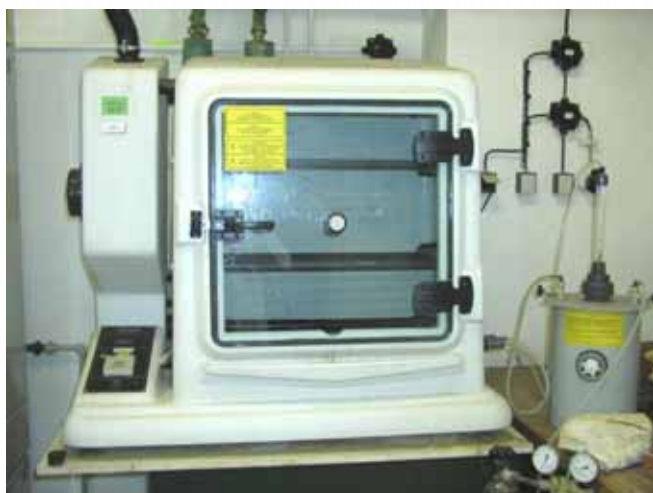
Obr. 2: Zařízení pro dvoufázové cyklické zkoušky – nalevo kondenzační komora s dávkovačem plynného SO 2 pro zkoušku dle DIN 50018 – 2.0 S, napravo zařízení pro urychlenou povětrnostní zkoušku s kondenzací vlhkosti a expozicí pod UV lampami dle tabulky 4 standardu ČSN EN ISO 16474-3
