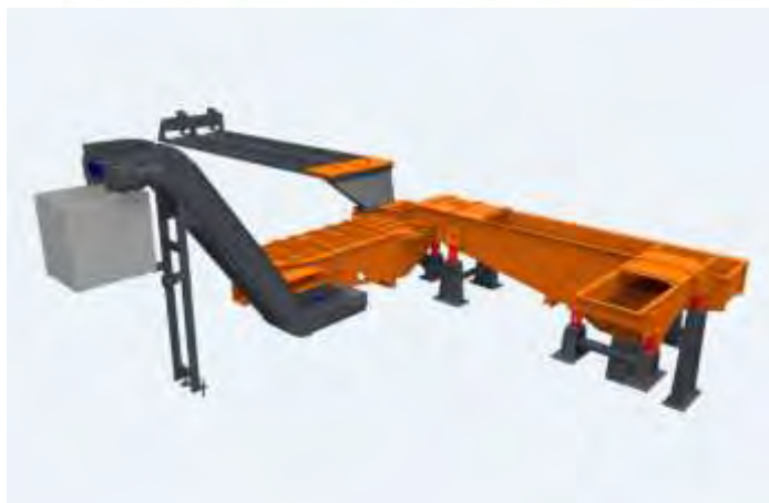
Obr. 2: Příčný skluz s násypkou písku u vstupní komory přepravují sypký formovací písek do třídící násypky pod tryskací komorou
