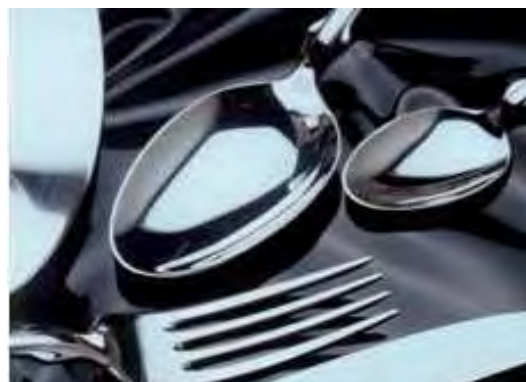
Obr. 1b: leskle pracující stříbrící lázeň, leskutvorná přísada na bázi sloučenin antimonu
