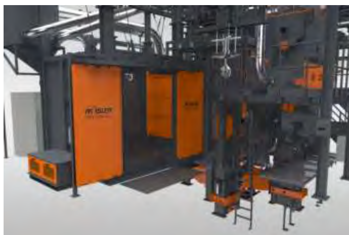
Obr. 1: Výstupní kabina s rovnou dopravníkovou podlahou vede tryskací médium a zbytkový písek do prosévací násypky pod tryskací komorou. Odtud je směs transportována do čistícího systému tryskacích médií
