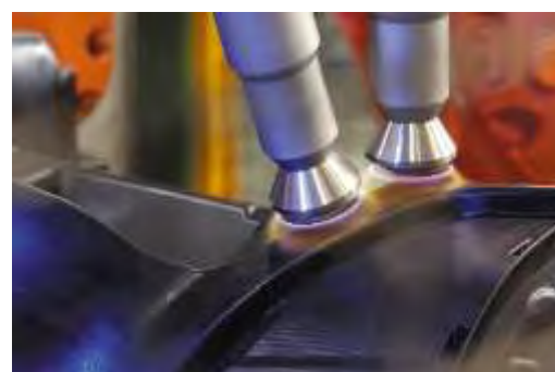
Úprava povrchu plazmou. (Zdroj Plasmatreat)
