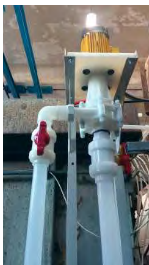
Obr. 9, 10, 11 a 12: Instalace PVDF čerpadla s filtračním aparátem vně nádrže. Filtrace a cirkulace lázně chemického niklování. Linka chemického niklování.
