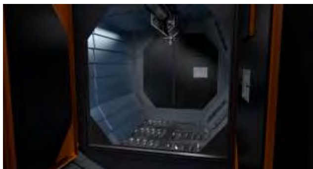
Obr. 1: Srdcem průběžného závěsného tryskacího zařízení RHBD 22/27-F je tryskací komora z otěruvzdorné austenitické manganové oceli. Pro dodatečnou ochranu proti opotřebení je komora obložena vyměnitelnými chromovými litými deskami o tloušťce 25 mm
