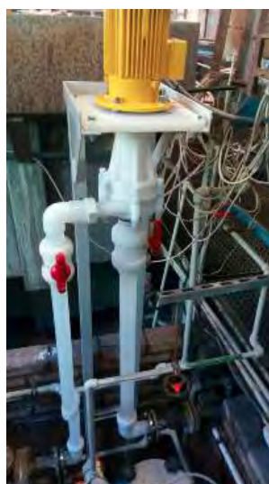
Obr. 9, 10, 11 a 12: Instalace PVDF čerpadla s filtračním aparátem vně nádrže. Filtrace a cirkulace lázně chemického niklování. Linka chemického niklování.
