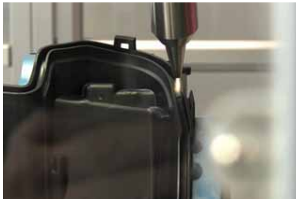
Fyzikální předúprava povrchu. Aktivace PP atmosférickou plasmou před lepením.
