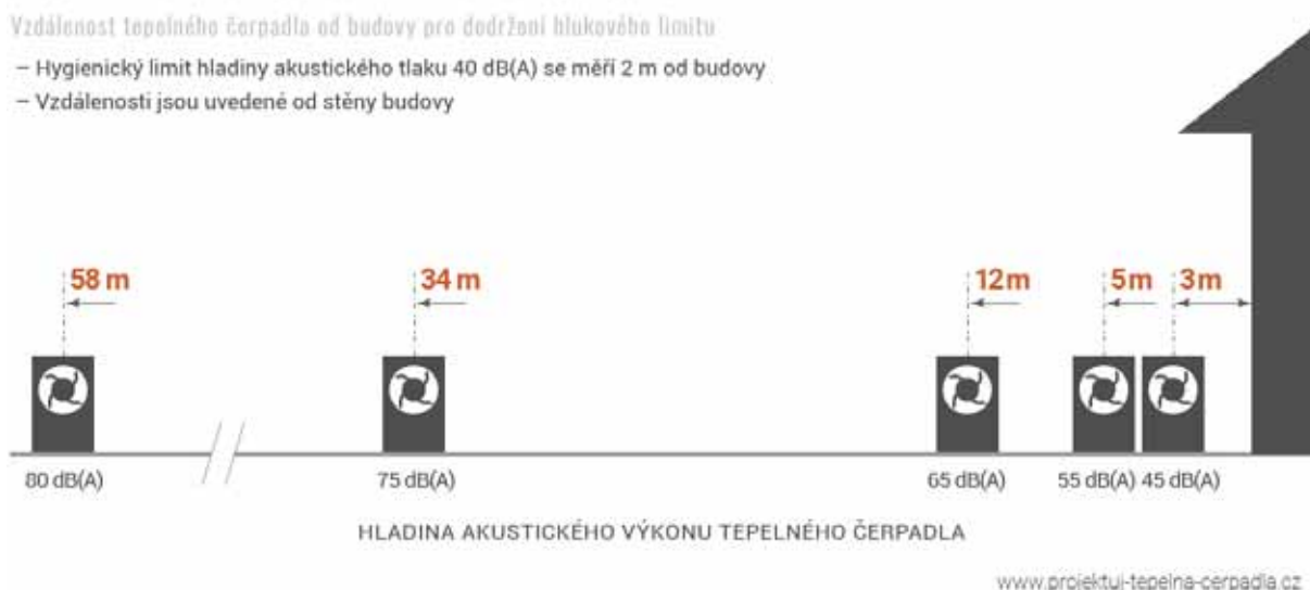
Obr. 2: Hodnoty akustického výkonu tepelného čerpadla v závislosti na vzdálenosti od budovy, Zdroj: GT Energy
