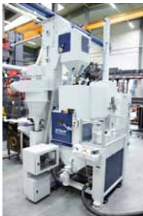
Obr. 1: Promyšlený koncept stroje RWS 1200 se dvěma protilehlými satelity umožňuje nakládání a vykládání druhého satelitu během procesu tryskání. To ušetří až 85 procent neproduktivního času
