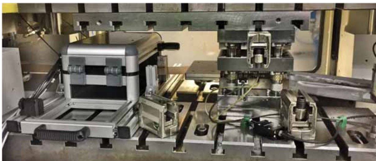
Obr. 5: Systém Recognoil pro účely kontinuální detekce homogenity a plošné koncentrace olejového filmu instalovaný do lisovacího stroje
