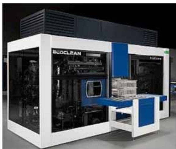
Obr. 2: Ecoclean_EcoCore – Pokud je třeba odstranit organické znečištění, moderní rozpouštědlové čisticí systémy zajistí více než jen účinné dosažení požadované úrovně čistoty. Splňují také vysoké ekologické standardy a díky integrované regeneraci média výrazně prodlužují životnost rozpouštědel
