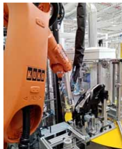
Plně automatizovaná výrobní linka světlometů. Čištění a aktivace povrchu v online režimu je součástí procesu lepení.
