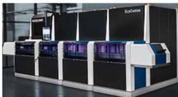
Obr. 5: EcoCvelox – EcoCvelox kombinuje odjehlování a čištění s vysokorychlostní automatizací a jednoduchým programováním odjehlování, takže tyto procesy lze provádět hospodárně v jednom kroku
