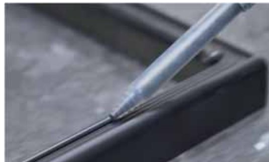
Volumetrický systém dávkování zajišťuje vysokou stabilitu průtoku lepidla z aplikační trysky.
