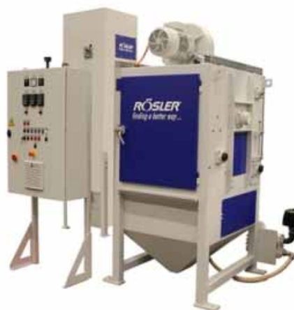
Obr. 2: Stroj RMBC 1.1-S, navržený pro objem dávky až 70 litrů, minimalizuje ruční nakládání a vykládání. Navíc je vybaven ekonomickým metacím kolem namísto drahého systému tryskání stlačeným vzduchem
