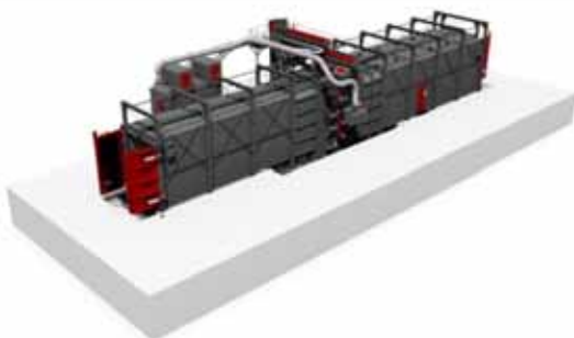
Obr. 1: Průběžné závěsné tryskací zařízení (l x v x š: cca. 20.000 x 6.500 x 6.000 mm) vybavené předkomorou, tryskací komorou a výstupní komorou je obvykle osazeno 8 až 16 turbínami, které jsou vertikálně přesazeny ve čtyřech řadách a jsou uspořádány do tvaru X. Tím je zajištěno vynikající otryskání ocelových konstrukcí na všech místech
