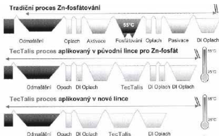
Obr. 4: Příklad rozdílu tradičního Zn – fosfátování a moderních předúprav povrchu pomocí Ti-Zr pasivace (snížení energetické a časové náročnosti procesu předúprav povrchu) [8]
