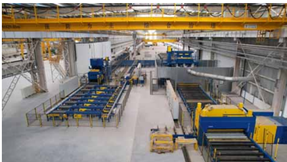
Obr. 1: Plně automatická a propojená konzervační linka představuje pro CMCS klíčovou investici pro vstup na trh stavby osobních lodí. Krátké výrobní časy s vysokou stabilitou procesu a minimálními náklady na zaměstnance zajišťují konkurenční výhodu při zpracování plechů a profilů.
