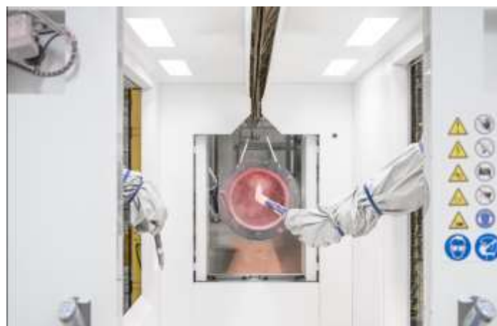
Obr.2: Lakování vnitřního povrchu zapouzdření
