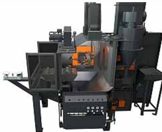
Obr. 2: Tryskáč stroj s otočnou komorou vybavený metacímí koly a injektorovým tryskáním zajišťuje energeticky efektivní provoz.
