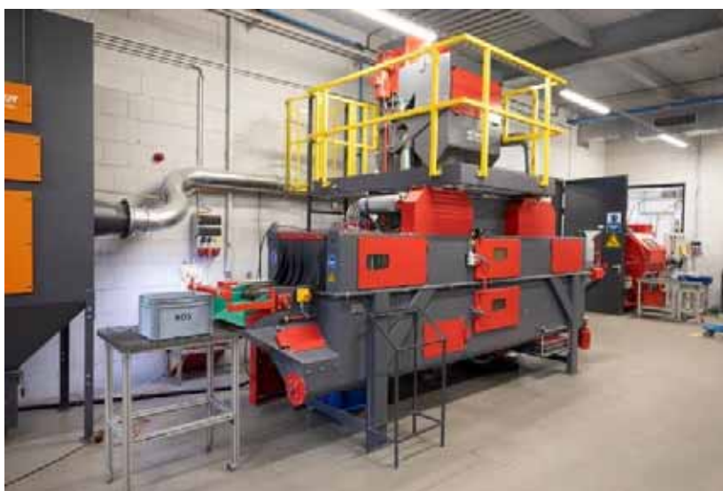
Obr. 1: Pro flexibilní zpracování rozdílných dílů z duroplastů a PPS-GF se používá průběžné tryskácké zařízení s drátěným pásem. Kromě velké produktivity ohromuje kvalitou tryskání při nízkých provozních nákladech.
