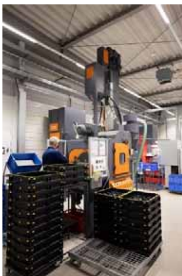
Obr. 3: Díky konstrukci RWS se dvěma komorami, kdy v každé z nich jsou umístěné čtyři satelity, mohou být díly během tryskání zároveň zakládány a vykládány. Toto řešení nejen zkracuje neproduktivní vedlejší časy, ale i zaručuje dodržení taktu stroje 40 sekund na odhrotování čtyř dílů.
