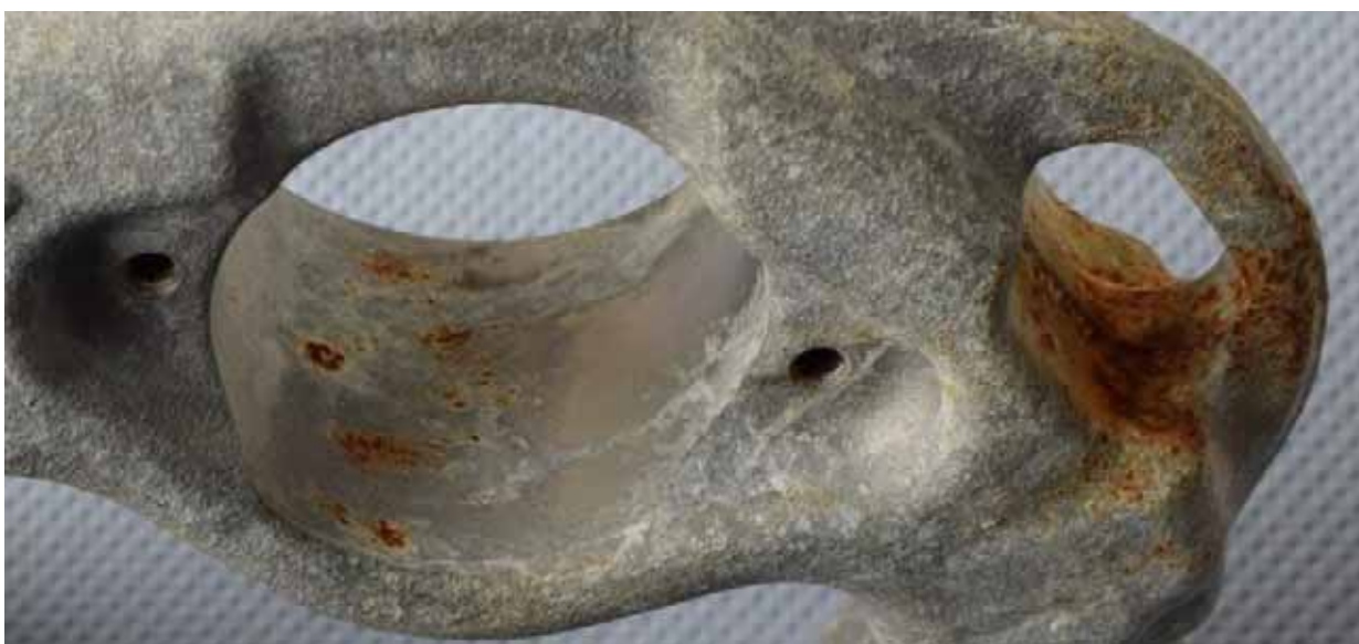
Obr. 2: Povrchová úprava dle VW 13750, TL244, ofl-c643, ZnNi transparentní pasivace s utěsněním. Fotografie dílu po 4 cyklech korozní cyklické klimatické zkoušky PV 1209 Výsledek: nevyhovuje, přítomna koroze základního kovu (červené koroze) ve velkém rozsahu
