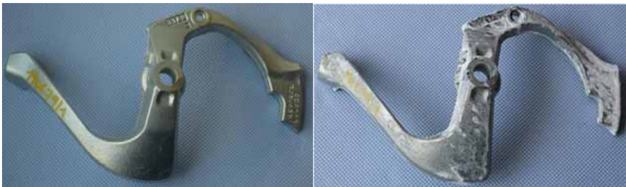
Obr. 1: Povrchová úprava dle VW 13750, TL217, ofl-c640, silnovrstvá pasivace. Fotografie dílu po 12 hodinách (vlevo) a po 168 hodinách expozice (vpravo) dle ČSN EN ISO 9227, metoda NSS. Výsledek: PÚ vyhovuje požadavkům bez koroze zinku i koroze základního kovu
