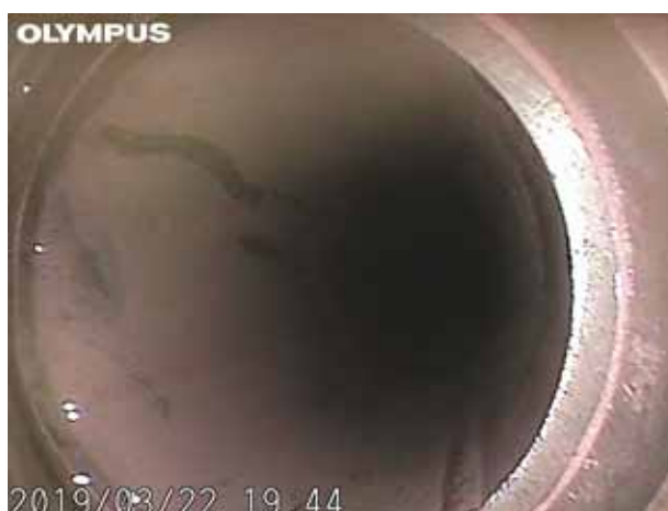
Ukázka vyčištění vnitřních povrchů teplosměnných ploch..
