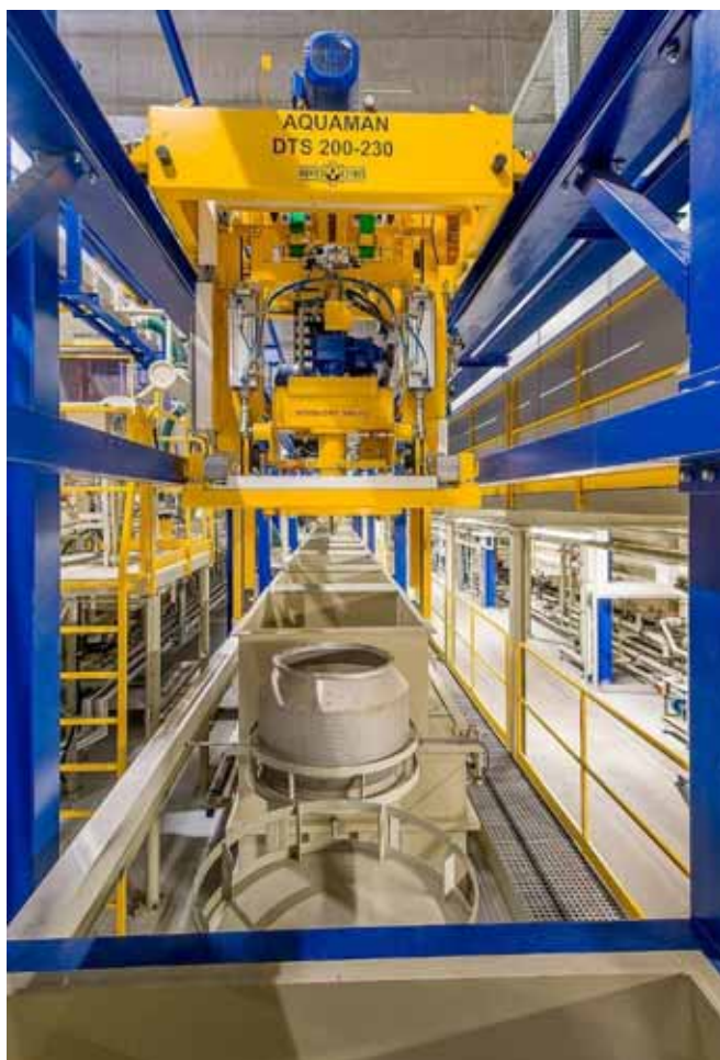
Obr. 4: Speciální zařízení pro následné úpravy hromadně upravovaných dílů
