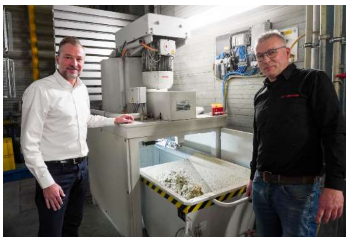
Obr.: Plně automatická odstředivka pro čištění kapalin ze dvou nádrží
