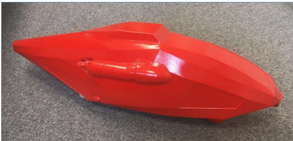
Obr. 9.: Maketa kapotáže bezpilotního vrtulníku vyrobená technologií sandprint určená pro test v aerodynamickém tunelu
