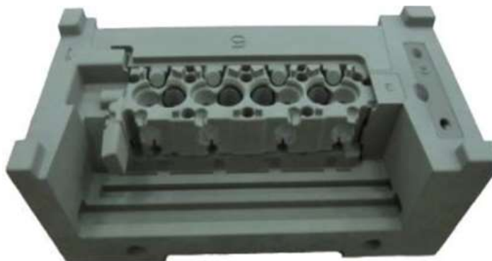
Obr. 2.: Část slévárenské pískové formy vytištěná technologií sandprint.
