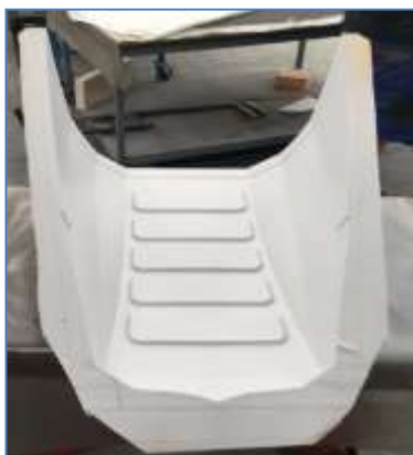
Obr. 5.: Laminovací forma na výrobu kapotáže vrtulníku vyrobená technologií sandprint
