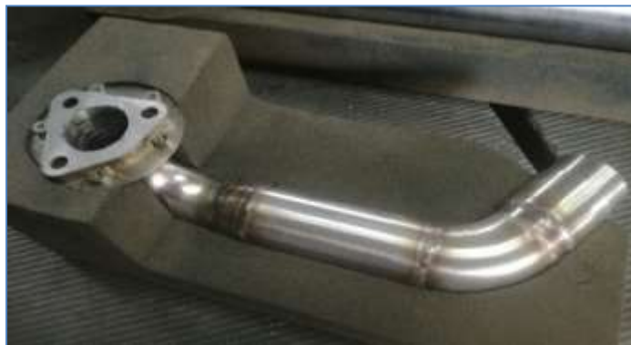
Obr. 3.: Svařovací přípravek vyrobený technologií sandprint svařencem kolena výfuku
