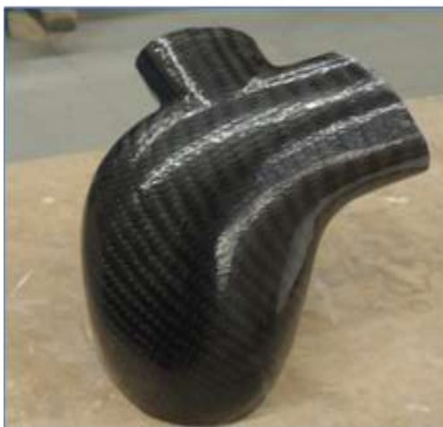
Obr. 4.: Kompozitový díl vyrobený za pomoci nevyztuženého modelu
