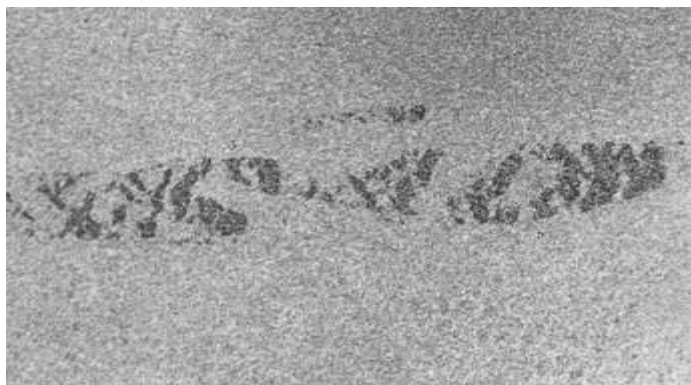
Obr. 10.: Zaválcované okuje a otlaky po okujích
