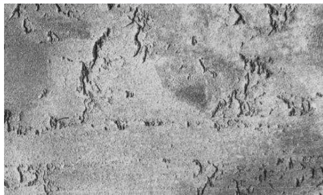
Obr. 10.: Zaválcované okuje a otlaky po okujích
