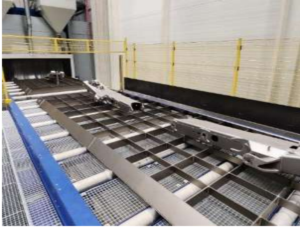
Obr. 2: Ocelové svařence po průjezdu tryskačem s válečkovou trati
