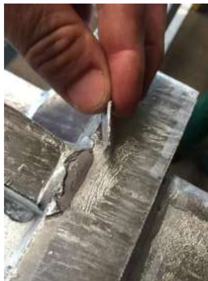
Obr. 4: Extrémní tloušťka povlaku žár. zinku na svaru s výsledkem odlupování se povlaku
