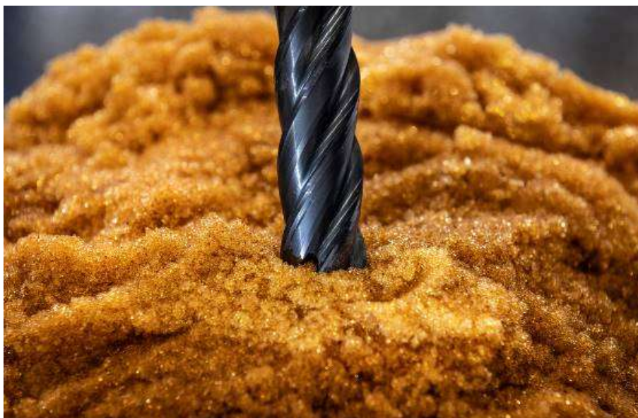
Obr. 1: Patentovaný proces DryLyte španělské technologické společnosti GPAINNOVA slibuje obzvláště homogenní a efektivní opracování břitů karbidových řezných nástrojů.
