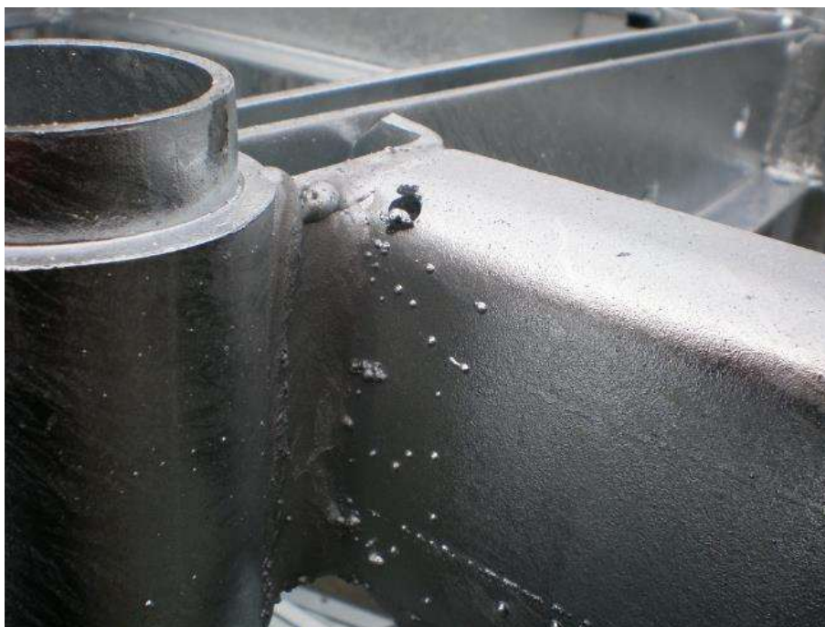
Obr. 9: Neodstraněné kuličky svarového kovu – i při používání separačního prostředku proti ulpívání kuliček svarového kovu se často stává, že kuličky na plochách výrobku určeného k žárovému zinkování zůstanou a svářeč je následně neodstraní. Po pozinkování dojde k jejich zviditelnění a pokud se má provést jejich odstranění až po pozinkování, tak se snižuje životnost protikorozní ochrany výrobku. Kuličky se odstraní i s povlakem žárového zinku a odstraní se až na základní materiál, který je nutno chránit proti korozi způsobem, který předepisuje norma ČSN EN ISO 1461, ale žádná z těchto metod nedosahuje kvalit povlaku žárového zinku.
