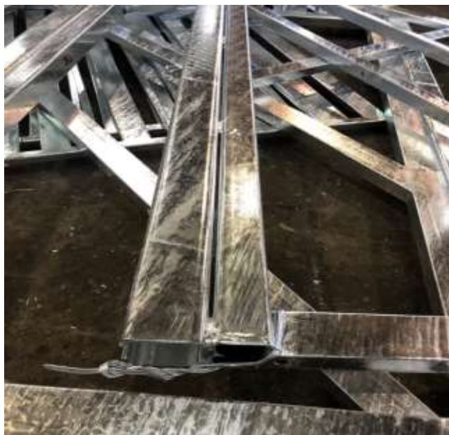
Obr. 2: Ideální výsledek pozinkované svařované konstrukce
