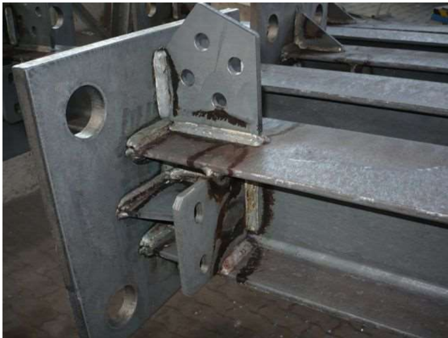
Obr. 8: Použití nevhodného nebo nadměrné použití vhodného separačního prostředku – kontaminace plochy výrobku určeného k žárovému zinkování separačním prostředkem není pro obsluhu zinkovny na začátku procesu viditelná a projeví se až po pozinkování. Nevhodný nebo nadměrně použitý separační prostředek vytvoří na ploše výrobku film, který nelze při žádném kroku chemické předúpravy před žárovým zinkováním odstranit. Plocha v tomto místě nebude chemicky očištěna na kovově čistý povrch, aby v tomto místě mohl při ponoření do tekutého zinku vzniknout povlak.
