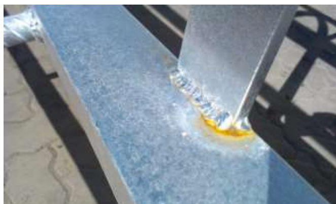
Obr. 5: Porézní svar – v pórech zůstanou zbytky tavidla po chemické předúpravě výrobku před žárovým zinkováním a při žárovém zinkování nedojde k utěsnění těchto pórů. Když dojde k ovhčení konstrukce a svaru, chloridy z pórů spustí v póru korozi a korozní produkty železa začnou vytékat ven. Nejedná se pouze o estetickou záležitost, protože s postupem času začne docházet i k poškození povlaku žárového zinku.
