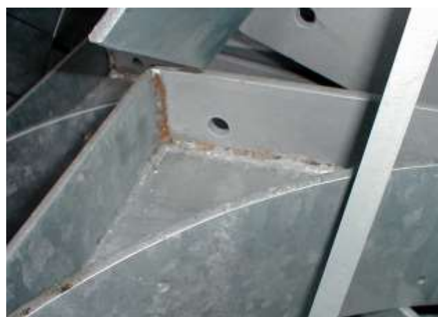
Obr. 5: Porézní svar – v pórech zůstanou zbytky tavidla po chemické předúpravě výrobku před žárovým zinkováním a při žárovém zinkování nedojde k utěsnění těchto pórů. Když dojde k ovhčení konstrukce a svaru, chloridy z pórů spustí v póru korozi a korozní produkty železa začnou vytékat ven. Nejedná se pouze o estetickou záležitost, protože s postupem času začne docházet i k poškození povlaku žárového zinku.
