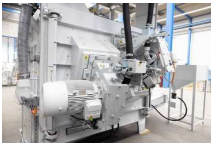
Obr. 3: Obě vysoce výkonná metací kola Rutten Gamma 400 lze snadno vyklopit z tryskacího prostoru. Tento technický detail umožňuje jednoduchou a rychlou údržbu metacích kol a výměnu ochranných desek v tryskací komoře.
