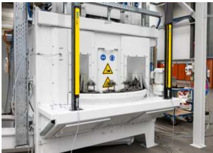
Obr. 2: Na otočném stole se nachází 15 satelitů se specifickými držáky dle dílů, na které nakládací a vykládací systém zákazníka automaticky umístí jeden nebo více obrobků. Díly se transportují strojem ve 20sekundovém taktu.
