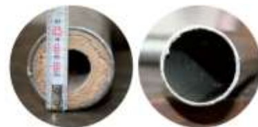
Obr. 2: znečištění uvolněné z čištěného systému
