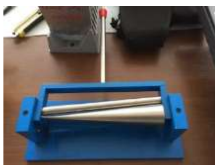
Obr. 35: Zkouška a) ohybem b) zahloubením
