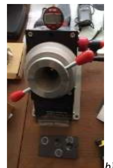
Obr. 35: Zkouška a) ohybem b) zahloubením
