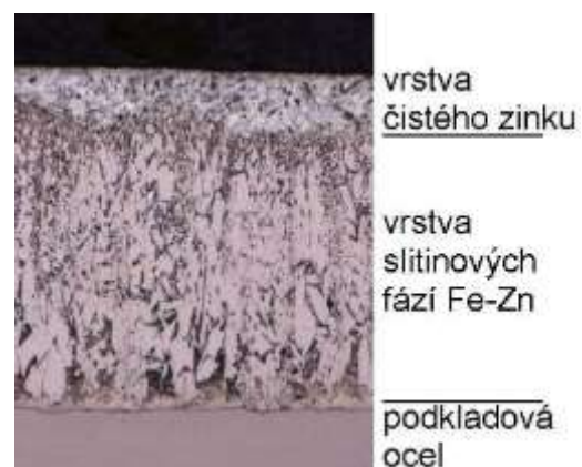
Obr. 3: Povlak na oceli uklidněně křemíkem
