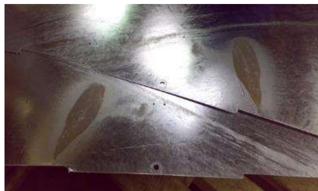
Obr. 23: Těsně zavěšené součásti
