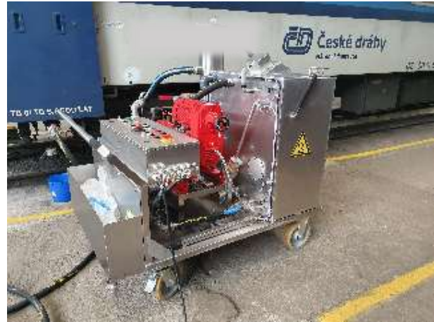
Obr. 6. a 7: napojení RWR na vakuovou toaletu
