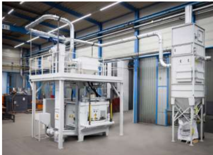
Obr. 1: Satelitní taktovací tryskací zařízení RST 200-S15 je navrženo pro kuličkování různých dílů převodovek v krátkém čase. Díky prostorné inspekční plošině jsou komponenty pro přepravu a přípravu tryskacího média, stejně jako ovládací skříň, snadno dostupné.
