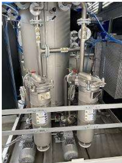
Obr. 3: Vertikální integrace dvou standardních zaplavovacích nádrží snižuje tvorbu usazenin a zabraňuje vzniku kapes s nečistotami, což vede k delší životnosti lázně. K tomu u verzí L a XL přispívá také zvýšený výkon destilátu až 180 l/h a standardně dodávané plynulé vypouštění oleje.
