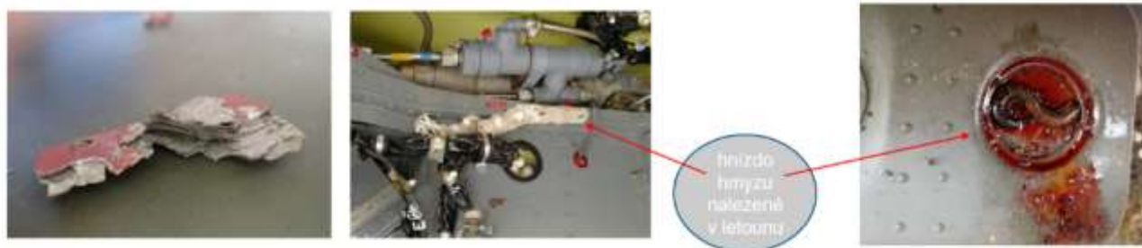
Dopad korozní agresivity CX na letoun
